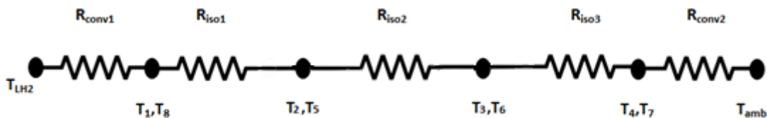
Figura 6 - Esquemática simplificada das resistências térmicas
