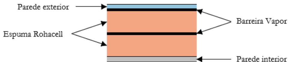
Figura 7 - Sistema de isolamento baseado em espuma Rohacell. (Winnefeld et al., 2018) Adaptado
