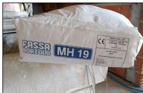
f) Pormenor de norma e marcação CE em saca de reboco à base de cal e cimento.
