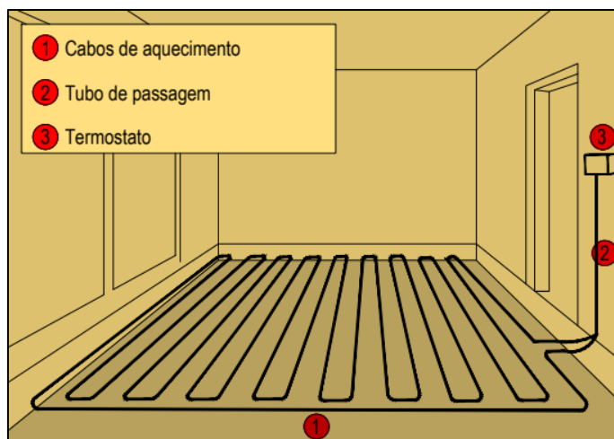
Figura 3.52 – Esquema de implantação do pavimento radiante elétrico (1).
