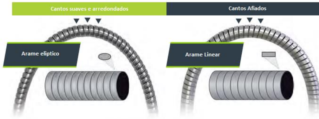
Figura 69 – Arame elíptico e arame linear [68]
