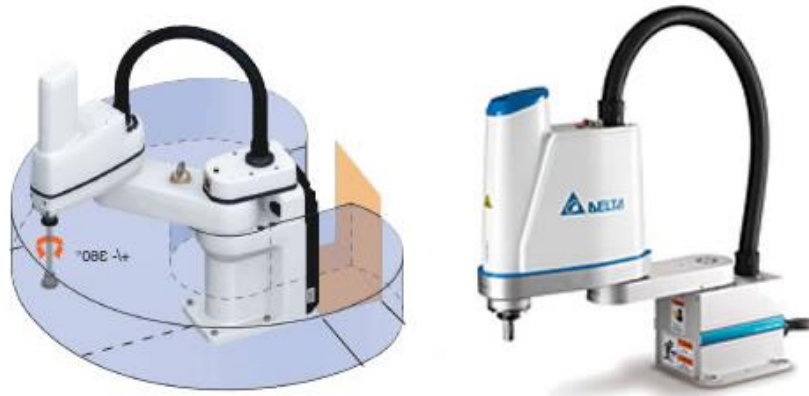
Figura 23 – Robô SCARA e respetiva área de trabalho [36]
