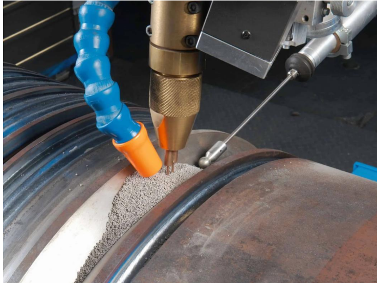
Figura 48 – Apalpador em funcionamento [59]
