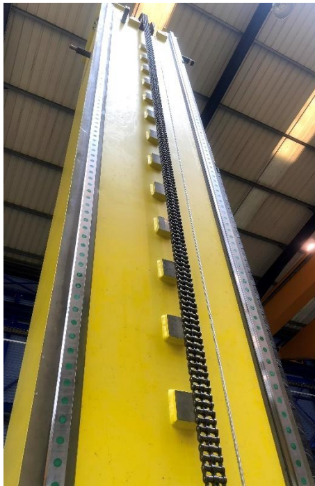
Figura 94 – Elevação do braço através de corrente de rolos duplos
