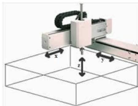
Figura 20 – Robô cartesiano e respetiva área de trabalho [33]
