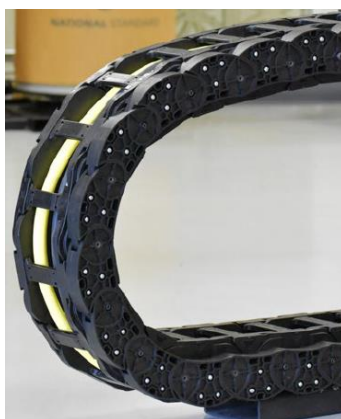
Figura 71 – Esteira porta cabos [66]
