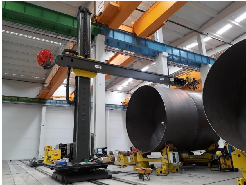
Figura 39 – Coluna de soldadura de base para o projeto
