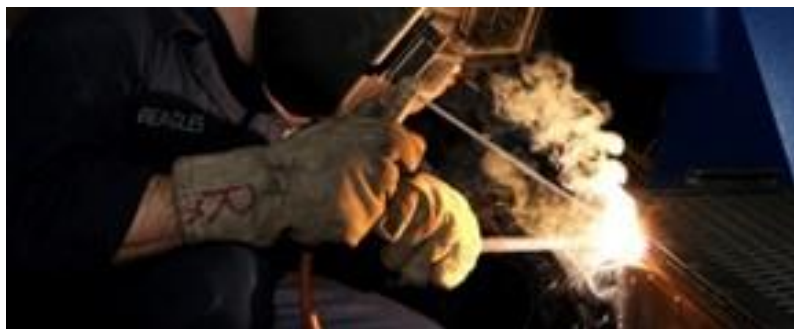
Figura 6 – Soldadura através de eléctrodo revestido [16]
