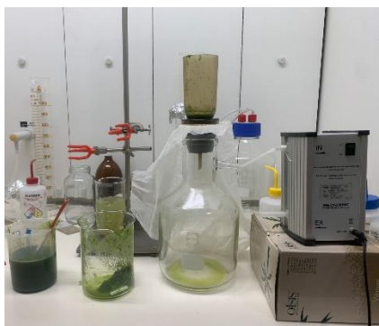
Figura 3-4: Filtração a vácuo da biomassa.
