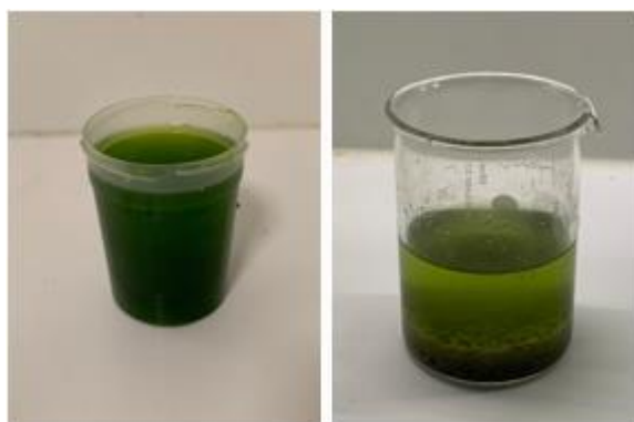
Figura 3-3: (a) Parte líquida para recuperação de sais, (b) Fração de amido decantada
