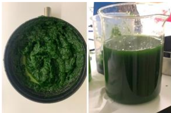
Figura 3-2: (a) Parte sólida e (b) líquida da biomassa após filtragem.
