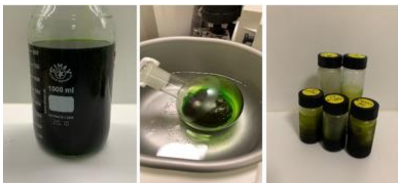
Figura 3-5: (a) Etanol utilizado na etapa 1 e na filtragem a vácuo; (b) Evaporação do etanol no rotavapor; (c) fração de lípidos.
