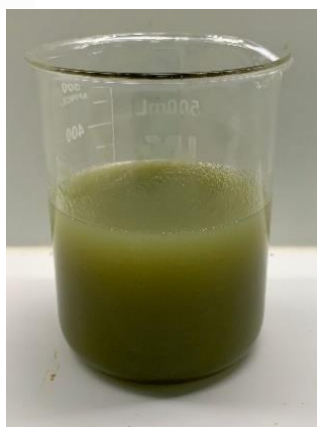
Figura 3-9: Parte sólida centrifugada após tratamento alcalino.
