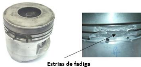
Figura 8 - Exemplo de fadiga num pistão [31].
