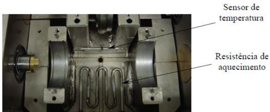
Figura 17 - Sistema de aquecimento constituído por uma resistência de aquecimento controlada por um termostato [43].
