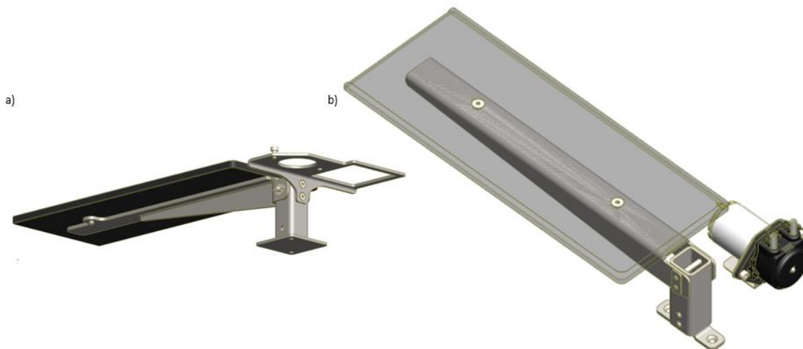
Figura 41 – Conjunto estrutural do sistema de lubrificação: a) 1º versão e b) versão final.
