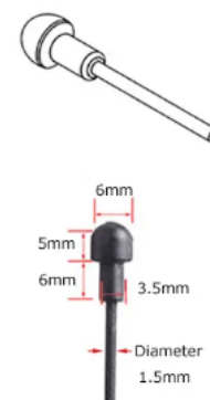
Figura 132 – Dimensões das pontas de engate dos cabos de aço para bicicletas [74].
