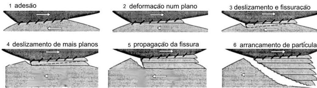
Figura 7 - Esquema da adesão e formação de filmes de transferência [8].
