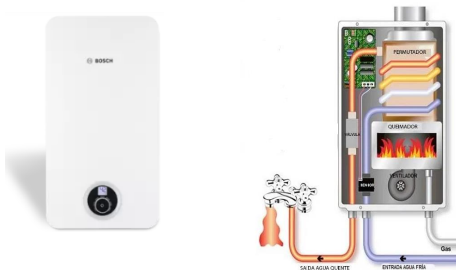
Figura 13 – Esquentador a gás (esquerda) e esquematização dos componentes de um esquentador de extração forçada (direita) [53, 54]
