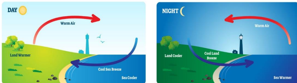
Figura 2.2. Efeitos térmicos que influenciam o recurso eólico: brisas marítimas (esquerda) e brisas terrestres (direita) [24].
