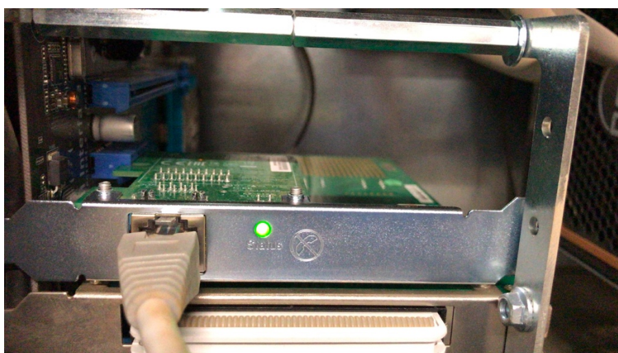
Figura 9 - Comunicação da rede/ placa de rede com a Máquina
