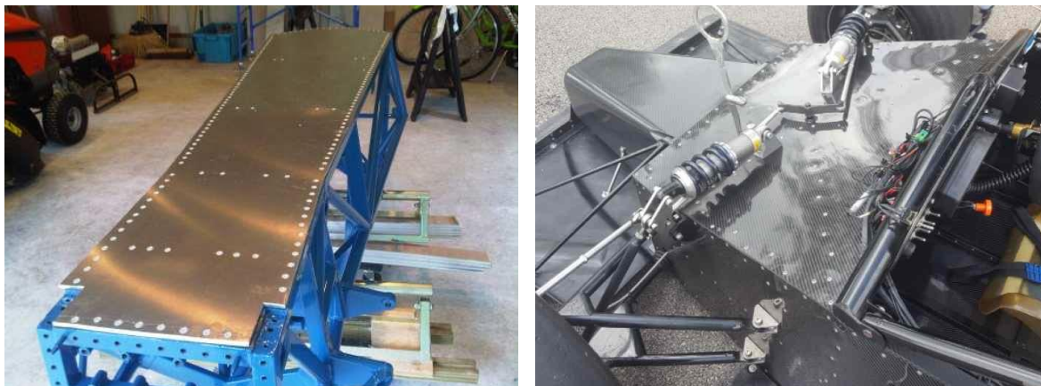
Figura 34 - Fundo Plano em Alumínio de um Formula Ford (Esquerda) [53] e Painéis Laterais em Laminados de Carbono no Osella PA200 (Direita) [54]
