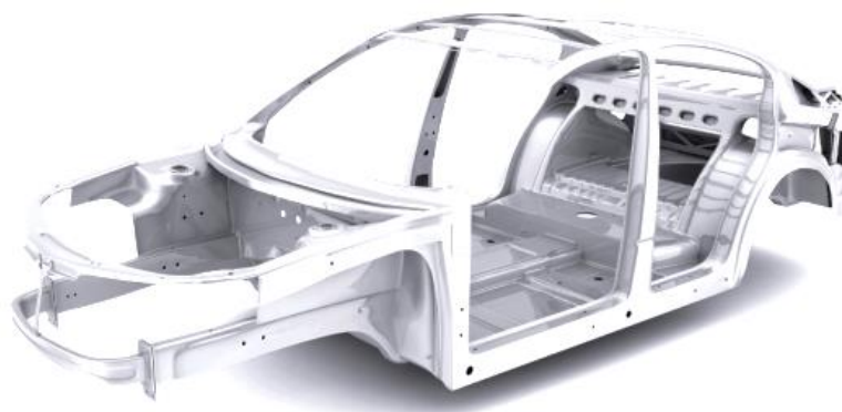
Figura 3 - Carroçaria tipo monobloco [14]
