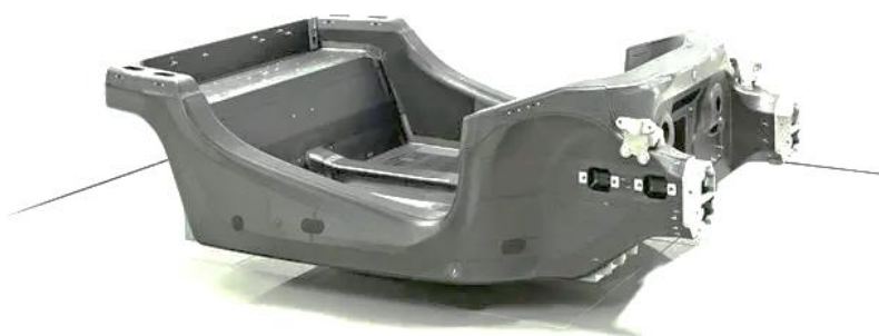
Figura 4 – Quadro estrutura Monocoque McLaren F1 [16]
