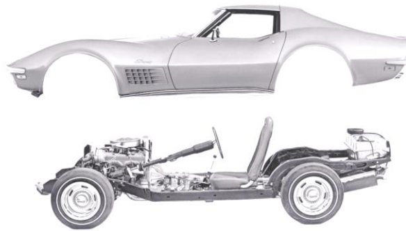
Figura 1 - Exemplo de quadro longarina e carroçaria Corvette C3 [12]
