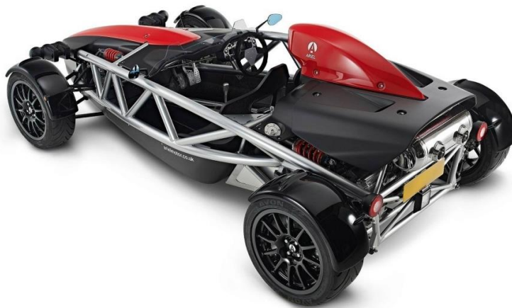
Figura 5 - Ariel Atom com quadro em estrutura tubular [17]
