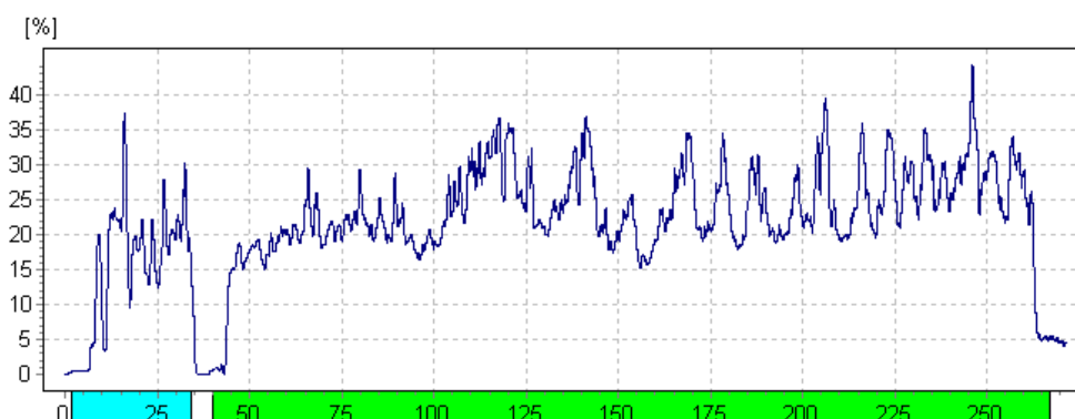
Figura 4.12 – Resultado ensaio Resistograph® - viga de pavimento do piso 1 em bom estado de conservação
