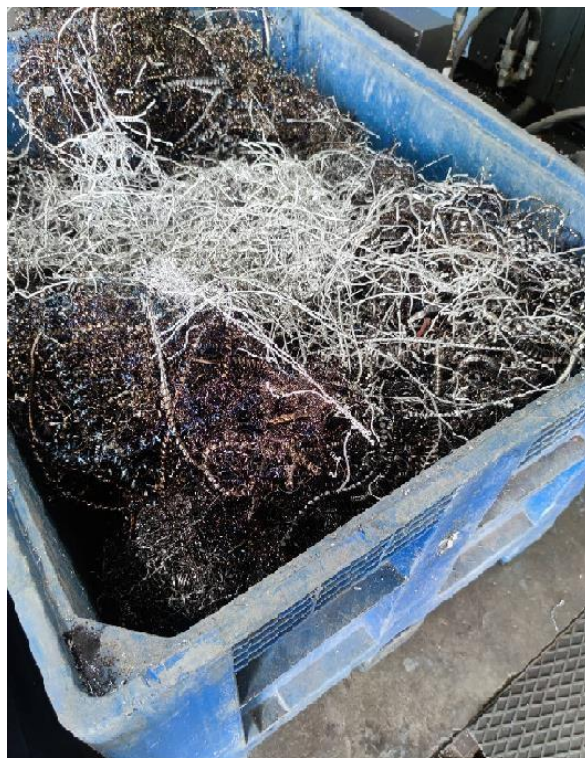
Figura 6 - Depósito de limalhas sem separação
