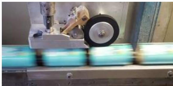
Figura 22 – Adição de verniz na soldadura da embalagem
