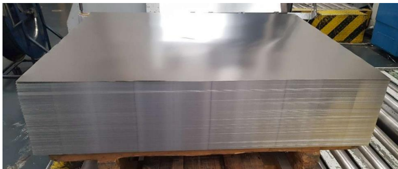
Figura 14 – Balote de folha após corte primário
