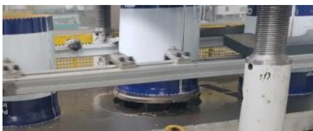
Figura 27 – Cravação do fundo ao corpo da embalagem
