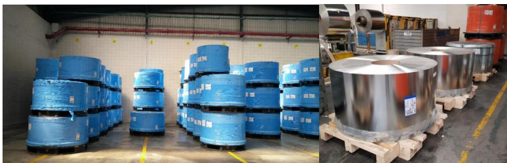
Figura 12 – Folha de flandres em bobinas
