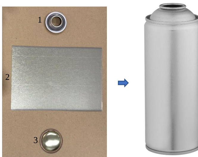
Figura 11 – Material constituinte para a produção de uma embalagem metálica para aerossol
