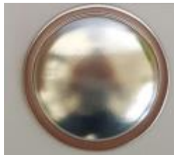
Figura 21 – Fundo de uma embalagem para aerossol depois de embutido e arredondado
