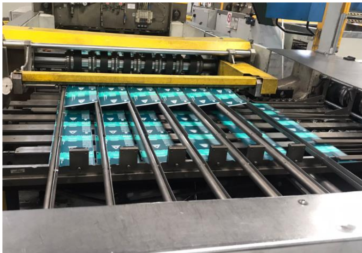
Figura 18 – Corte transversal da folha para se obterem corpos de embalagem para aerossol
