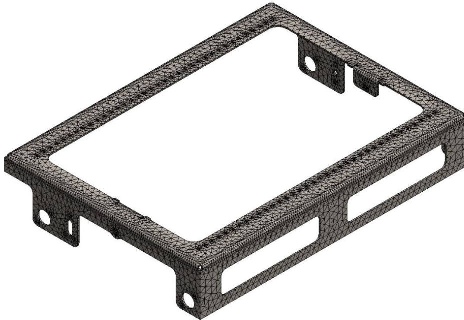
Figura 132 - Malha para a análise MEF da mesa superior
