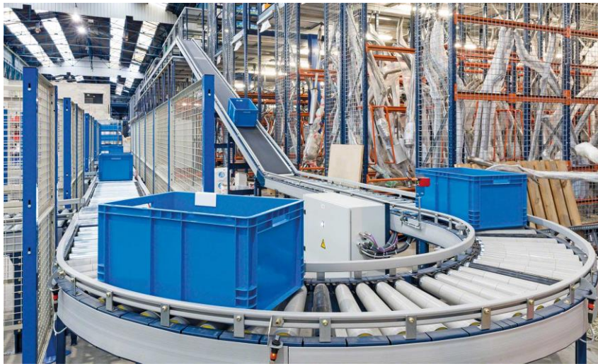
Figura 56 - Exemplos de transportadores de caixas [89]
