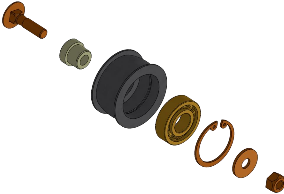
Figura 103 - Conjunto do rolete, vista explodida
