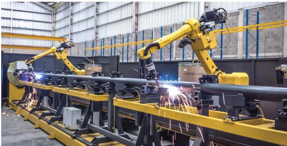
Figura 19 - Processo de soldadura MIG-MAG automatizado através de braços robóticos [30]
