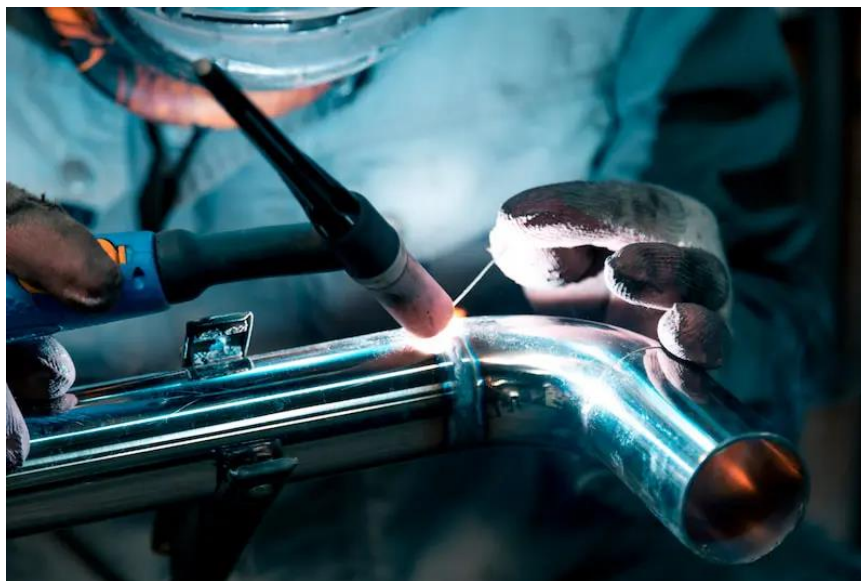
Figura 21 – Ilustração do processo de soldadura TIG [32]
