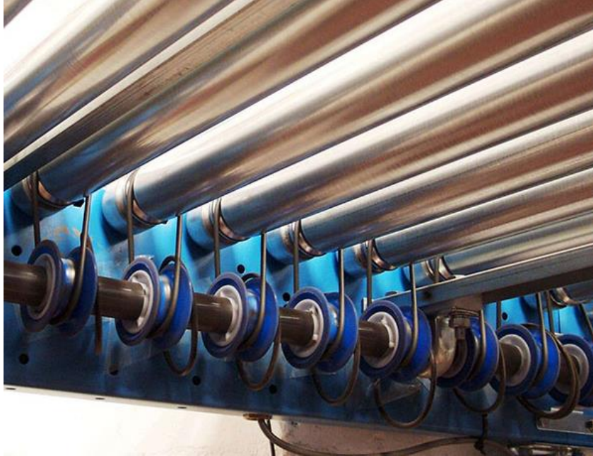
Figura 57—exemplo de um sistema line shaft [92]
