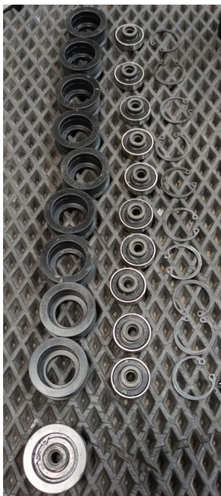
Figura 139 - Montagem dos conjuntos dos roletes
