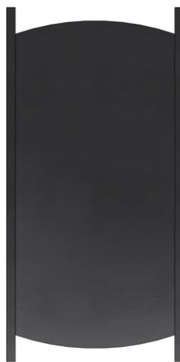
Figura 104 – Superfície do rolete ovalizada
