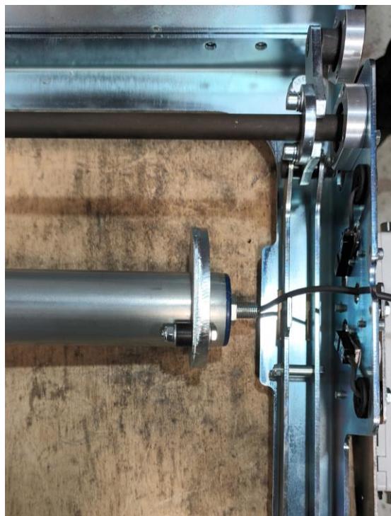
Figura 143 - Dificuldade de montagem do rolo motorizado
