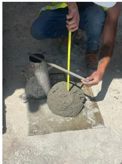
Figura 65 - Slump test (9º passo do procedimento)
