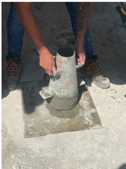
Figura 66 – Slump test (7º passo do procedimento)
