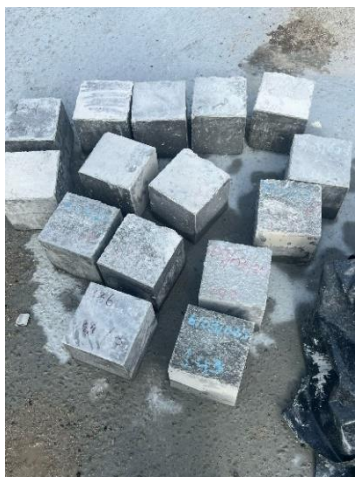
Figura 72 - Cubos desenformados e identificados
