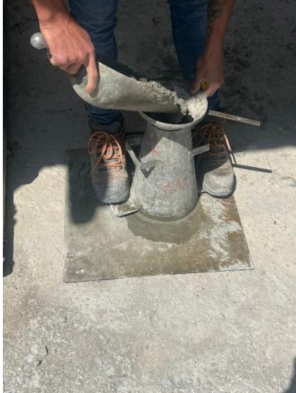
Figura 67 – Slump test (2º passo do procedimento)
