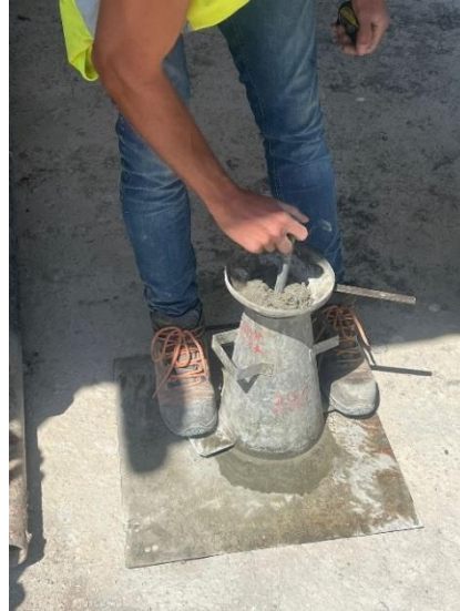
Figura 68 – Slump test (4º passo do procedimento)
