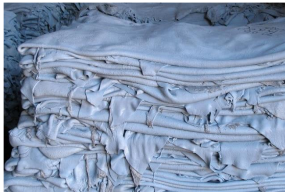
Figura 2.4 Peles em estado wet-blue [5]
