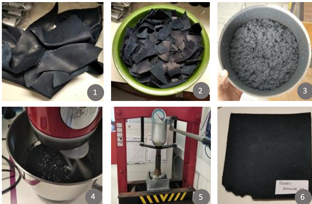
Figura 3.9 Processo de produção de aglomerados de couro
