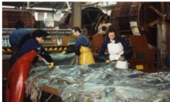
Figura 2.3 Pele em tripa a ser dividida [3]
