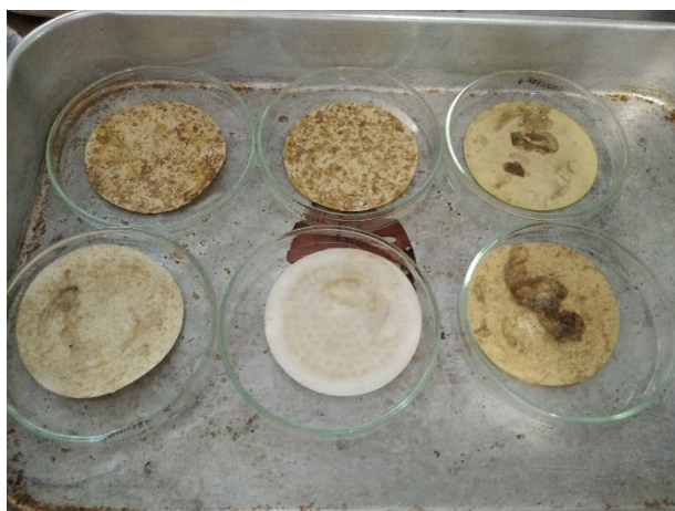
Figura 3.5 Resíduo sólido resultante da hidrólise
