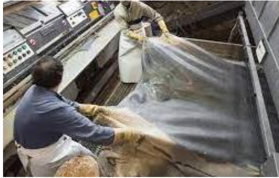
Figura 2.2 Processo da descarna [5]
