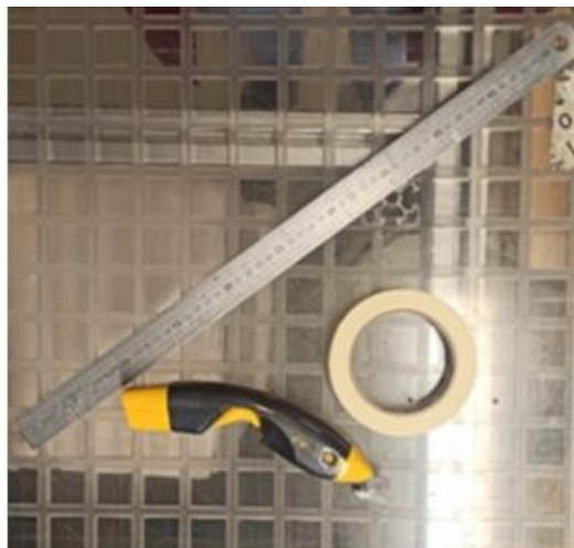
Figura 29 - a) Marcações realizadas no reforço com o auxílio da régua e da fita-cola e b) Fita-cola, régua e tesoura elétrica.
