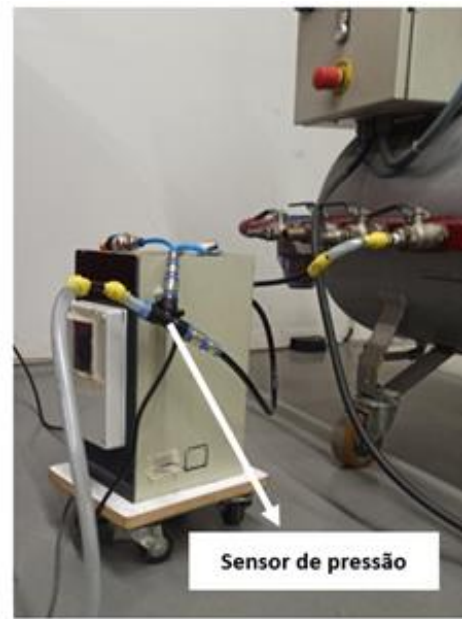
Figura 41 - a) Placa de aquisição de dados e b) Sensor de pressão.
