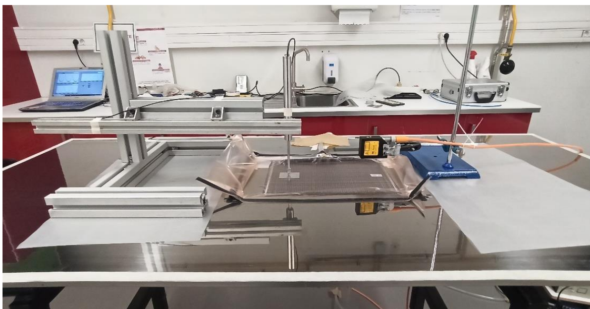
Figura 44 - Setup completo para um ensaio de compactação cíclica.
