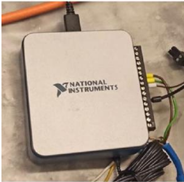
Figura 41 - a) Placa de aquisição de dados e b) Sensor de pressão.
