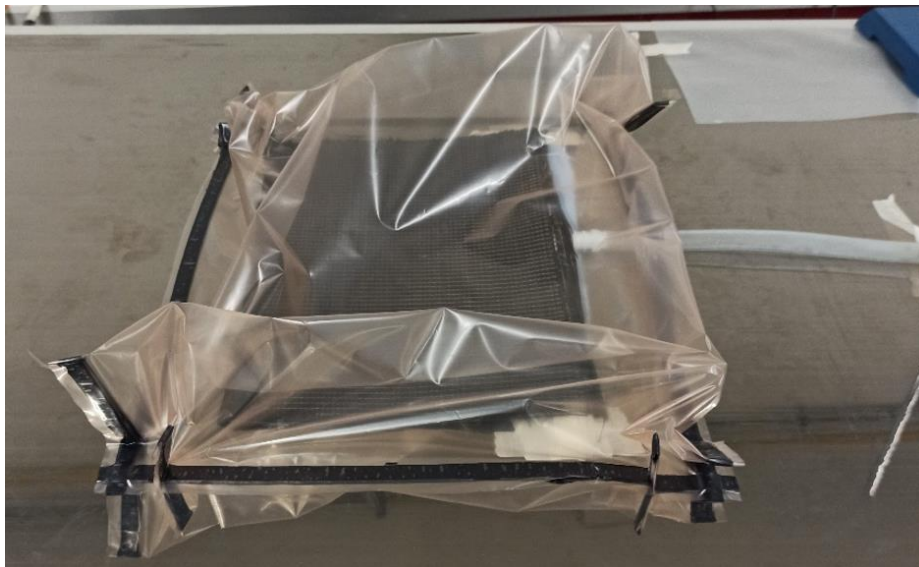
Figura 36 - Aplicação do saco de vácuo na mesa.
