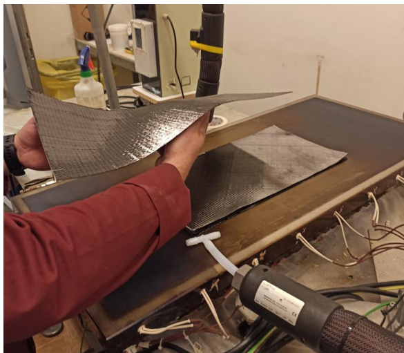
Figura 47 - Colocação dos reforços em cima do molde.
