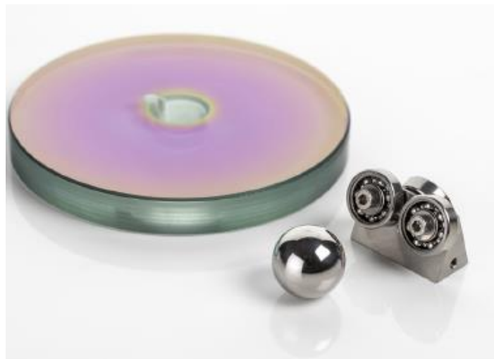
Figura 25 - Disco e esfera de ensaio para medição da espessura de filme.
