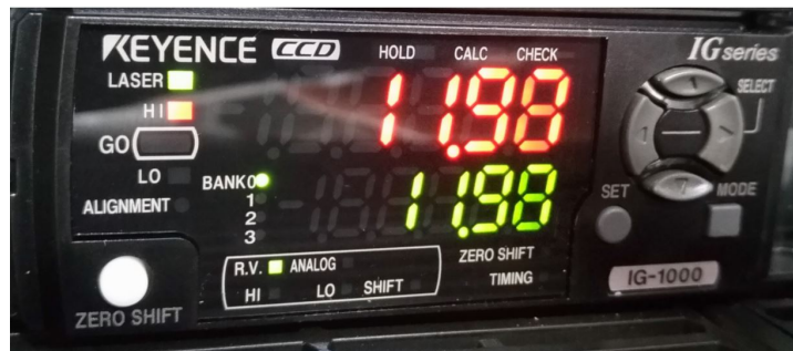
Figura 5.19: Resultado de um teste de medição a uma peça com altura superior ao valor pretendido
