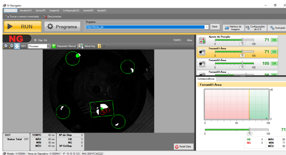
Figura 5.15: Teste a uma peça em que os furos centrais estão ausentes, peça não funcional
