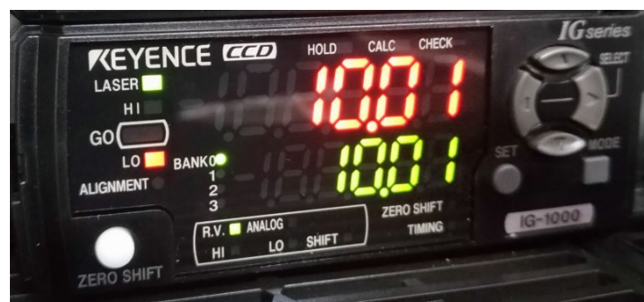
Figura 5.18: Resultado de um teste de medição a uma peça com altura inferior ao valor pretendido
