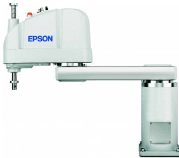
Figura 4.36: Robô Scara G6 da marca Epson
