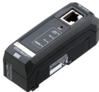
Figura 4.32: Representação do módulo DL-EP1
