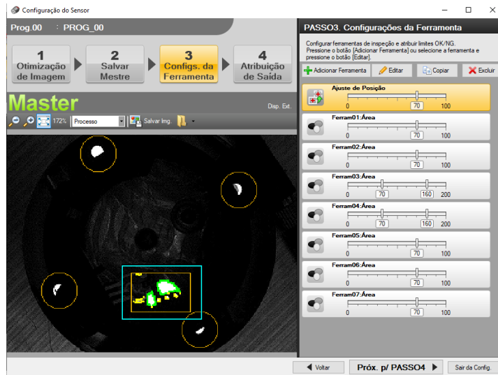
Figura 5.13: Representação da área de ajuste de posição e das sete ferramentas para detecção de presença de furos
