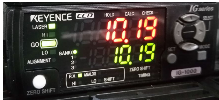
Figura 5.20: Resultado de um teste de medição a uma peça com altura compreendida no intervalo de tolerância estabelecido
