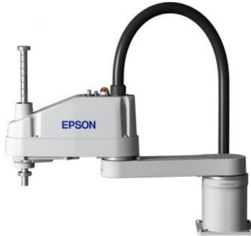
Figura 4.35: Robô Scara LS6 da marca Epson
