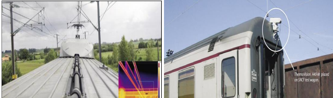
Figura 16 - Ensaios termográficos com câmara montada em um vagão. ([19])
