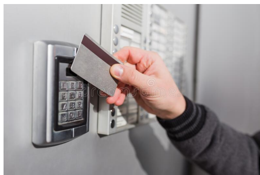
Figura 2.12: Exemplo do uso de uma etiqueta para abrir uma fechadura (Cartão de chave de segurança 2022)
