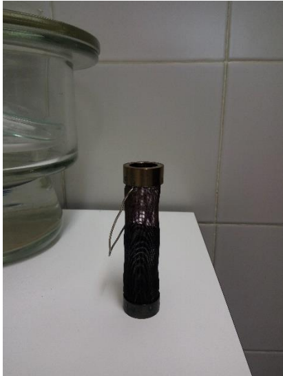
Figura 3.5: Cesto de pirólise com a amostra.
