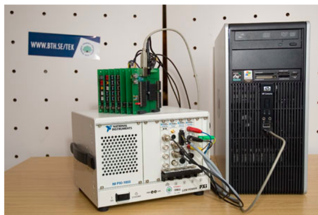
Figura 5: VISIR - laboratório remoto do BTH [Gustavsson et al. (2008)].
