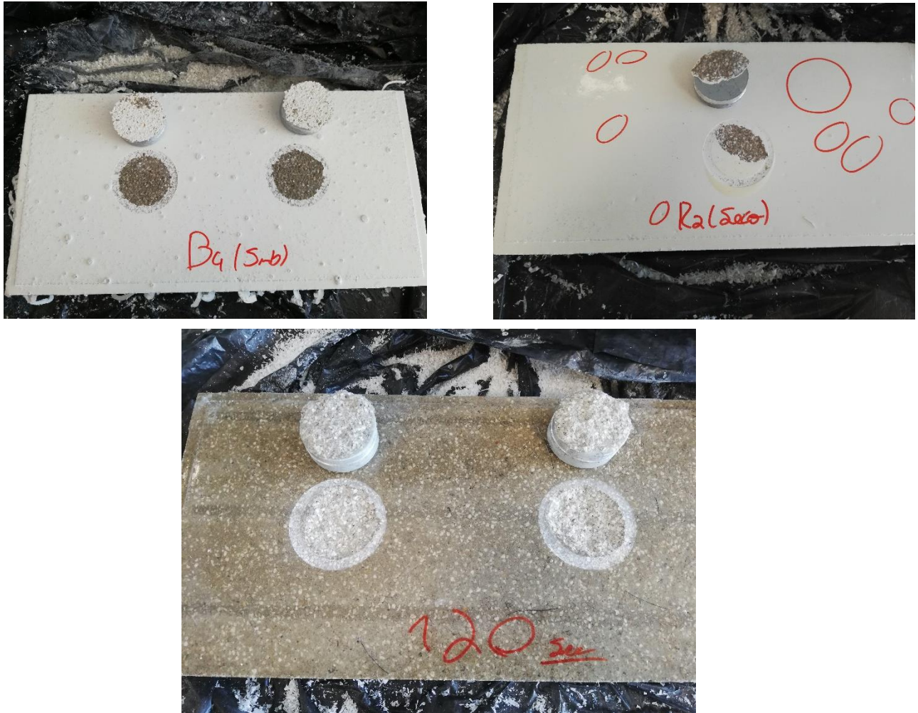
Figura A. 1 Exemplos dos diferentes tipos de fraturas – Superior esquerdo: Adesiva; Superior direito; Falha na cola com um pouco de falha no substrato; Inferior: Falha no substrato.
