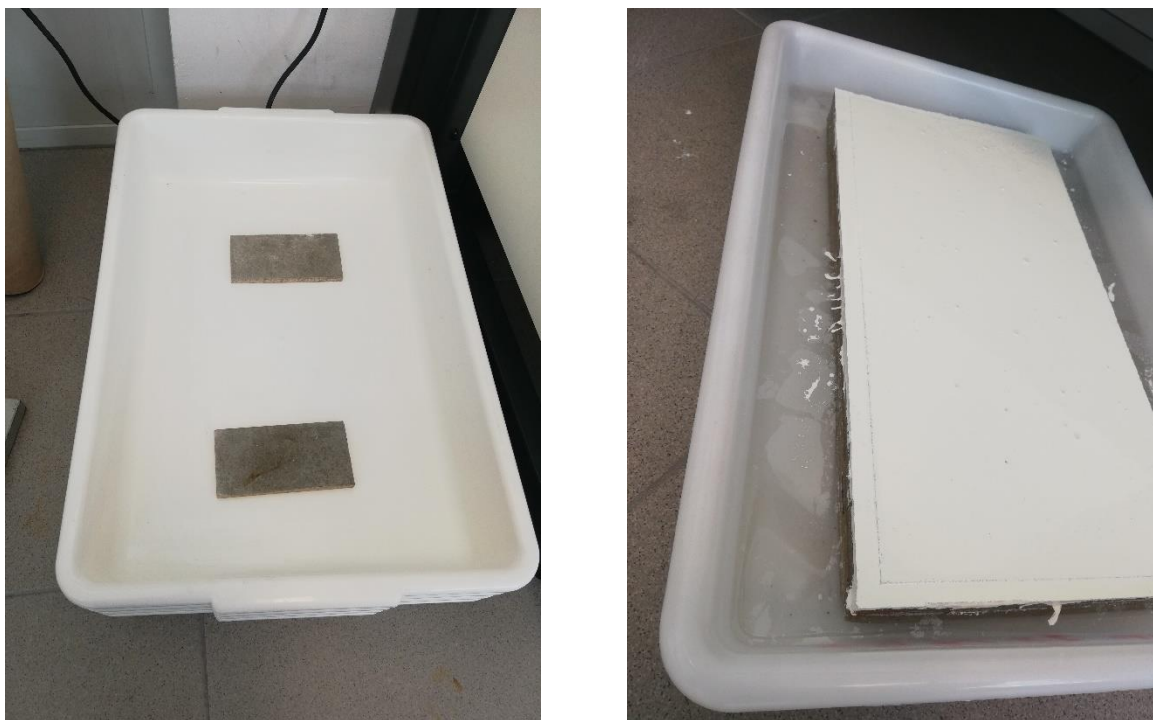
Figura 4. 1 Tabuleiro com os suportes (esquerda), Peça submersa com 1 cm acima do nível da água (direita)
