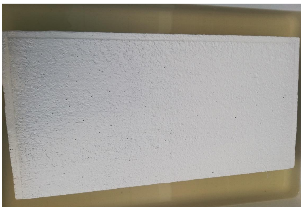
Figura 5. 2 Fotografia da aplicação do sistema D num substrato submerso, com base nos procedimentos descritos no capítulo 4
