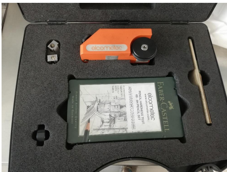
Figura 4. 16 Equipamento utilizado para a realização dos testes de Dureza a Lápiz, da elcometer
