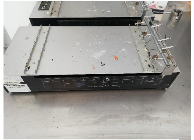
Figura 4. 9 Tira de vidro após um teste de secagem (Esquerda), registador de secagem BK Drying Recorder (direita)
