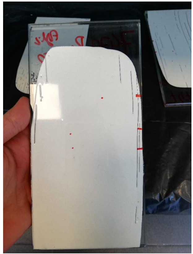
Figura 4. 5 Aplicador de 150µm e retângulo de vidro (esquerda), amostra aplicada e pronta para teste (direita)
