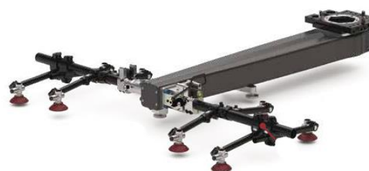
Figura 25 - Sistema transfer CCFT com componente em material compósito (adaptado de [92]).
