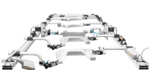
Figura 22 - Sistema transfer de 3 eixos com fixação superior [93].
