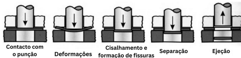
Figura 4 - Etapas da operação de corte (adaptado de [49]).
