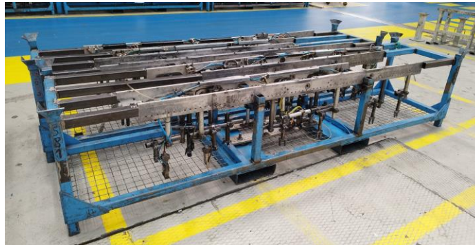
Figura 29 - Gavetas para armazenamento de sistema transfer
