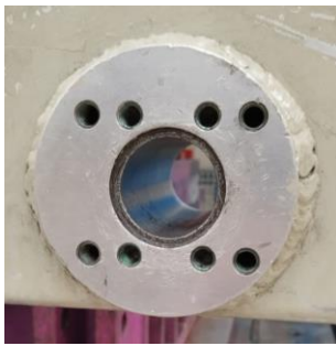
Figura 48 – Casquilho de alojamento para o aperto rápido na barra transfer.
