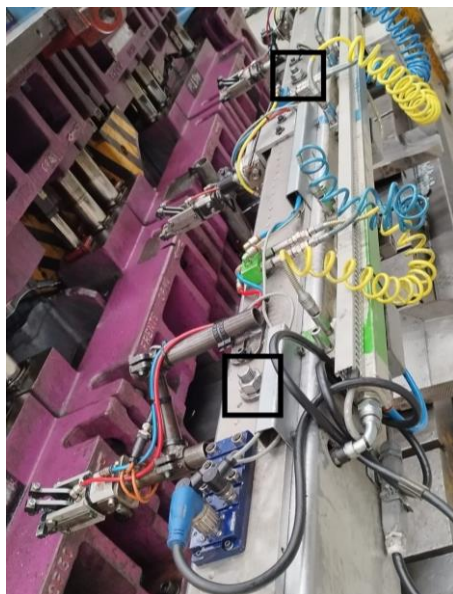
Figura 32 - Sistema transfer montado no exterior da prensa em barra transfer , com realce nos apertos roscados utilizados.
