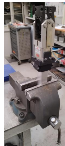
Figura 123 - Conjunto do suporte da garra fixo num torno de mesa.
