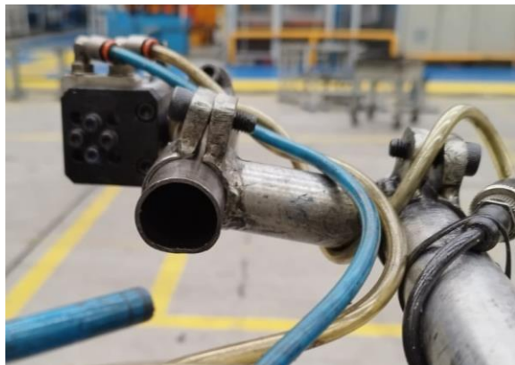
Figura 43 - Abas da junta deformadas no máximo e perfil tubular esmagado.
