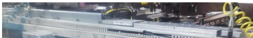
Figura 45 - Sobrebarra transfer levantada devido a aperto insuficiente à barra transfer da prensa.
