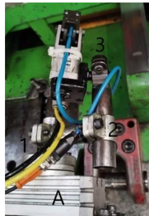
Figura 44 - Braço de sistema transfer . A - Componente de rotação; 1,2 e 3 - Juntas que permitem rotação.
