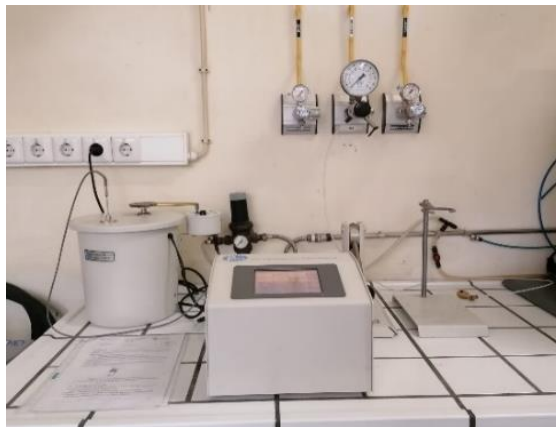
Figura B.1 - Equipamento para determinação do poder calorífico superior.
