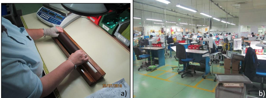
Figura 31 - a) Inspeção Visual efetuada por colaboradora; b) Sala de inspeção visual
