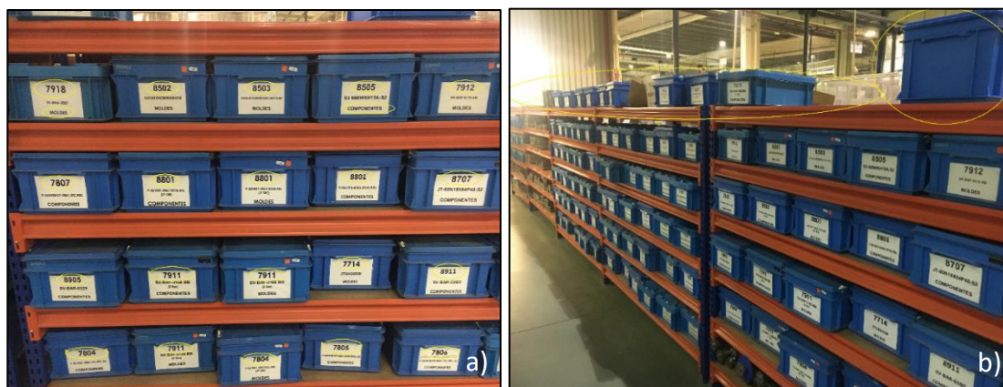
Figura 35 - a) Inexistência de organização por referência; b) Excesso de caixas na estante
