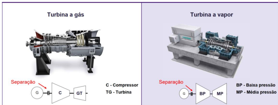
Figura 17 – Ponto de desacoplamento entre a turbina (a gás ou a vapor) e a máquina síncrona durante a conversão simples de uma unidade de produção termoelétrica em compensador síncrono. Adaptado de [91].
