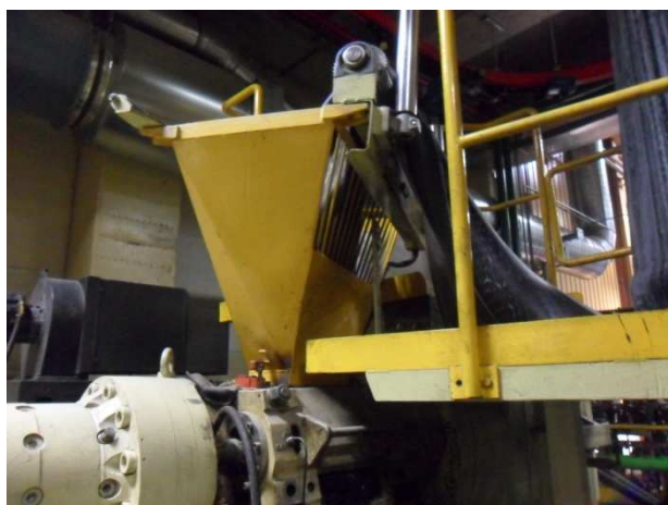
Figura 26 Tremonha da extrusora e folha de borracha.
