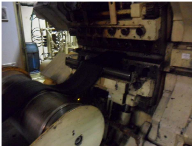
Figura 28 Cabeçote e fieira com o piso a ser extrudido.
