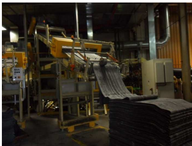
Figura 27 Passadeiras de alimentação e detetores de metais.
