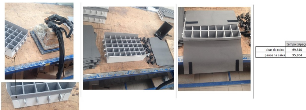
Figura 5.62: Explicação do processo de colagem e os respetivos tempos padrão.
