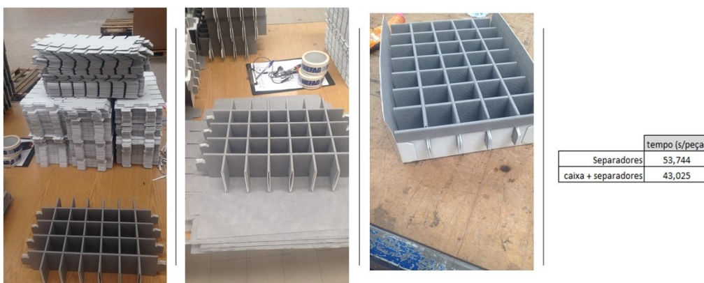
Figura 5.60: Passos da montagem do projeto em PP com tyvek e respetivos tempos padrão.
