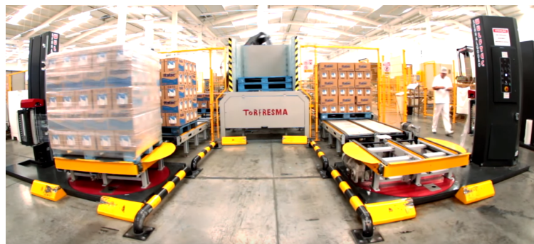
Figura 3.16: Envolvedoras fixas utilizadas no projeto de paletização de leite da Torfresma [57].
