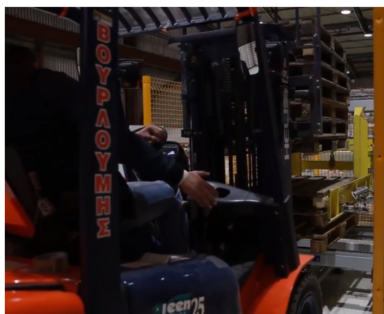
Figura 3.8: Colocação de paletes no dispensador de paletes [56].
