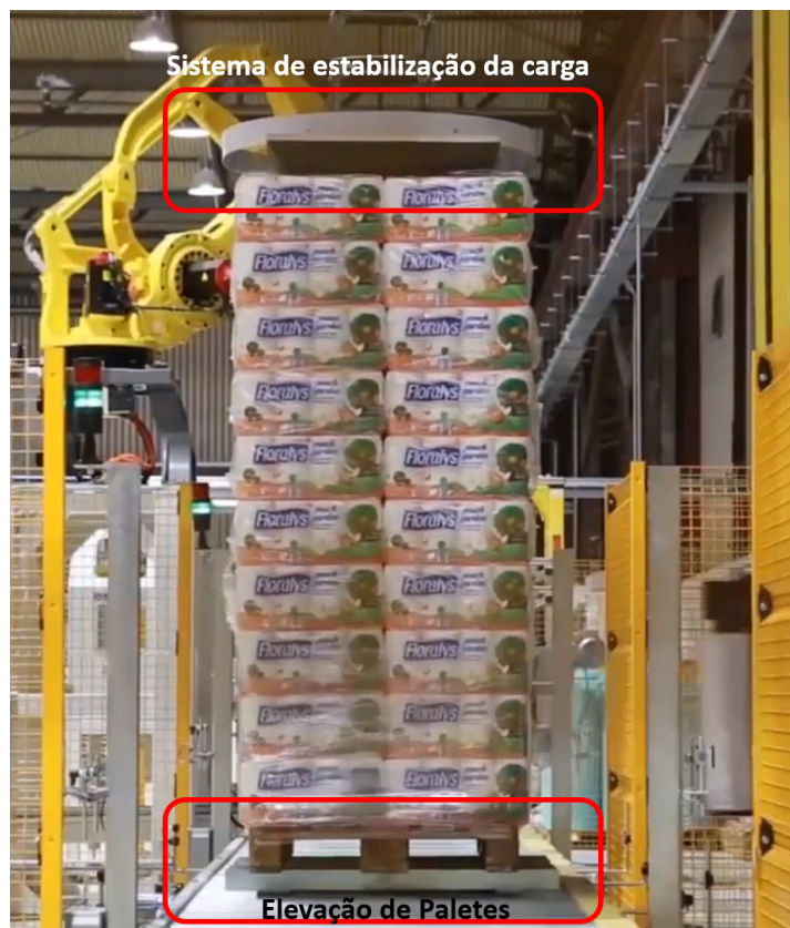
Figura 3.9: Máquina de envolvimento de filme protetor [56].
