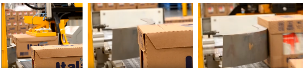
Figura 3.12: Desviador utilizado na linha de paletização [57].
