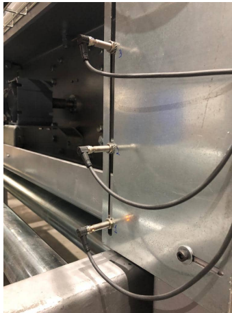
Figura 7.8: Sensores indutivos que identificam a posição da subida e descida do dispensador.
