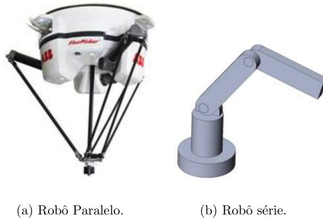
Figura 2.8: Robôs classificados consoante a sua estrutura cinemática [16].
