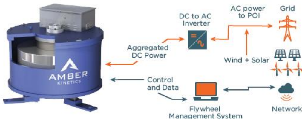
Figura 64 Esquema de ligação entre uma flywheel e a rede[49]
