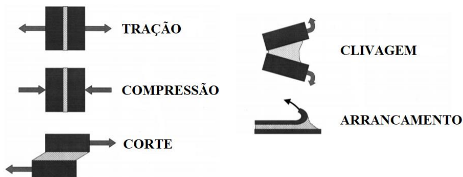
Figura 2 - Tipos de esforços aplicados em juntas adesivas [16]
