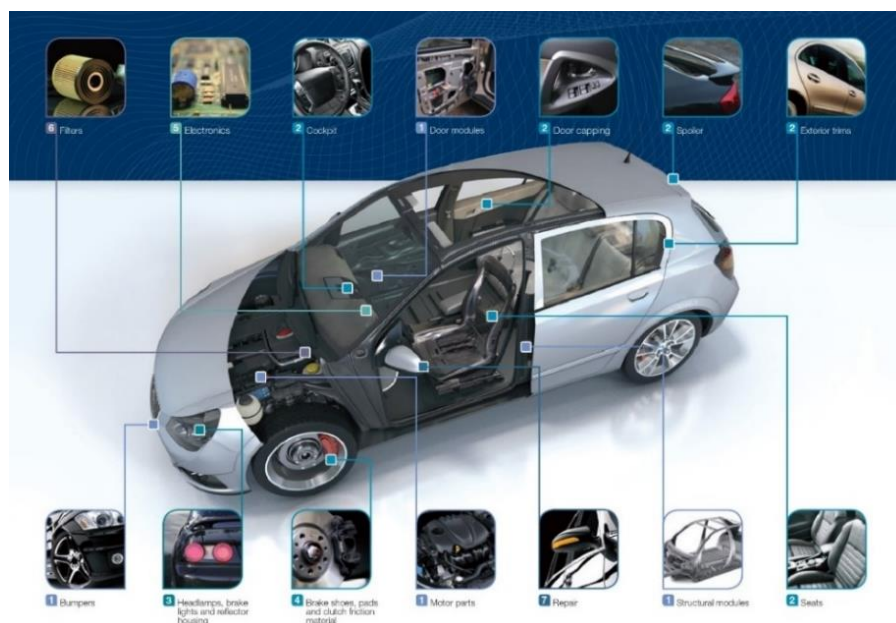
Figura 16 - Aplicação das ligações adesivas num automóvel [25]
