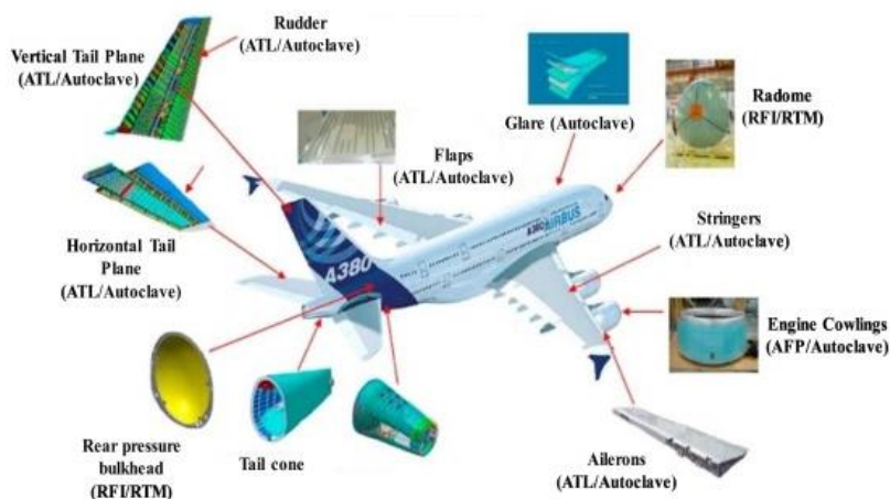
Figura 15 - Aplicação das ligações adesivas num avião [24]
