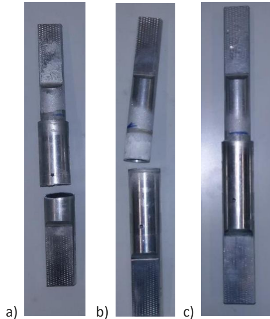
Figura 44 - Rotura registada numa amostra de provetes dos adesivos Araldite® AV138 (a), Araldite® 2015 (b) e SikaForce® 7752 (c) com L_0=40 mm
