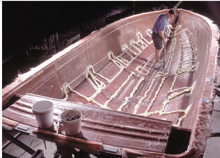
Figura 18 - Aplicação de ligações adesivas num barco [21]
