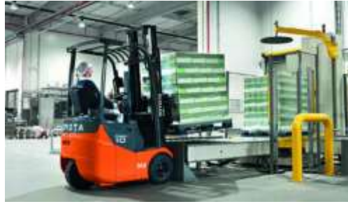
Figura 24 – Exemplo de equipamento de movimentação vertical (empilhador) [44]
