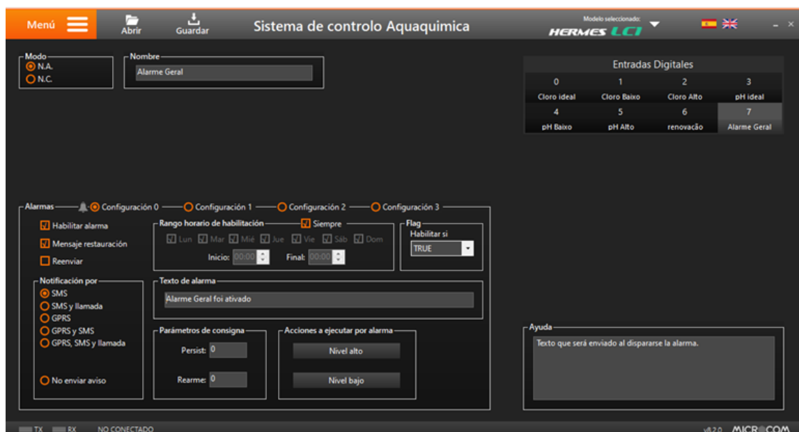
Figura 42- Configuração das entradas digitais do módulo GSM
