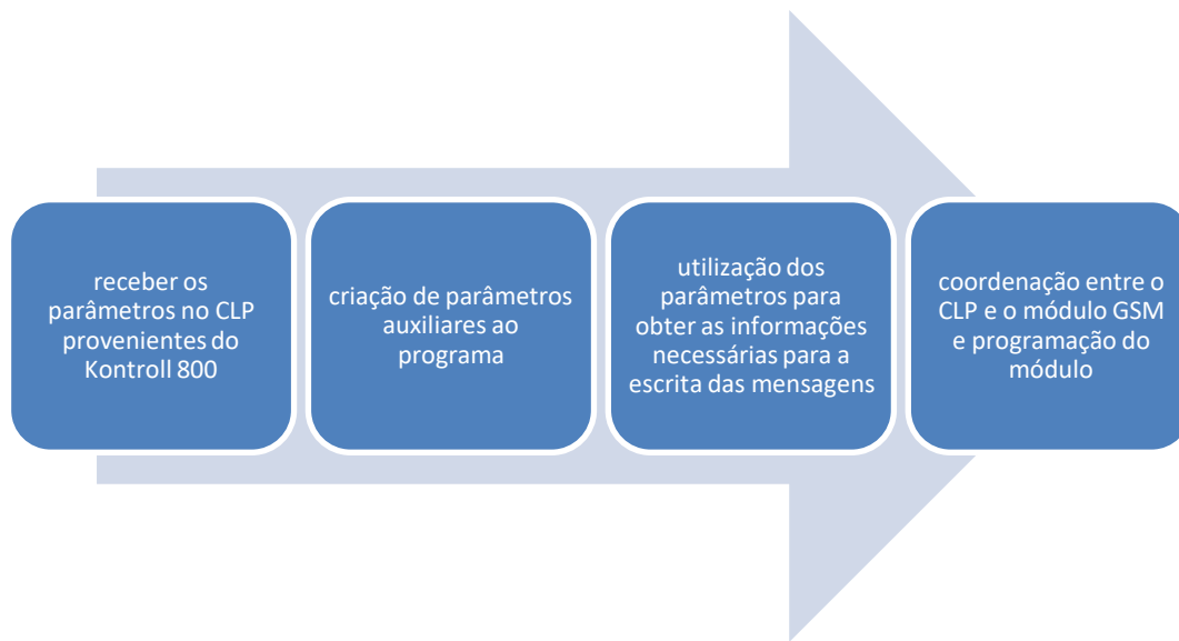
Figura 27 –Passos necessários para efetuar a programação do sistema
