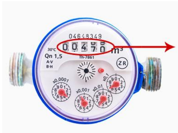
Figura 17-Painel de leitura de um contador de água [15]
