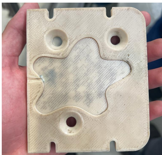
Figura 76 -Postigo impresso em ULTEM 9085F para utilização em sobreinjeção.
