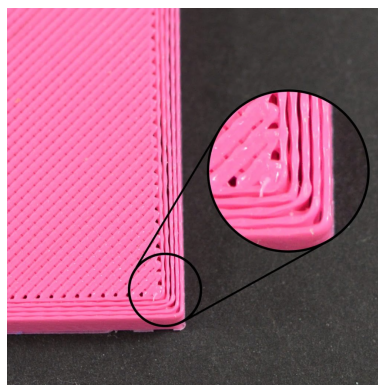
Figura 14 -Exemplo prático de under extrusion [62].
