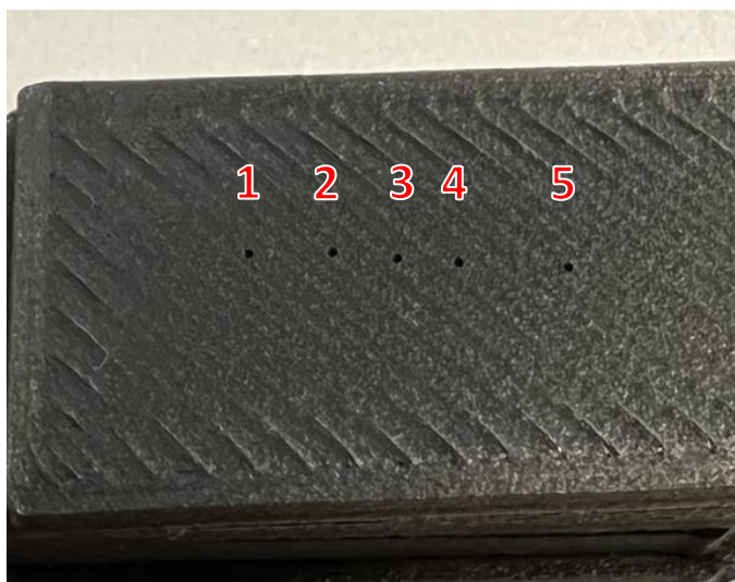
Figura 61 - Medições de leitura de dureza consecutivas.
