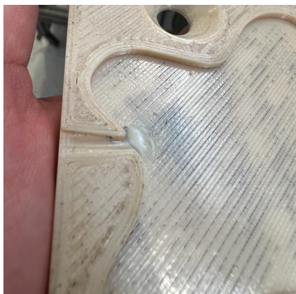
Figura 80 - Estrangulamento verificado no runner e gate do postigo.
