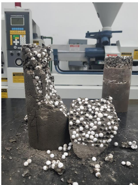
Figura 4.7 – Foto CP submetido ao ensaio de compressão TEPS1.
