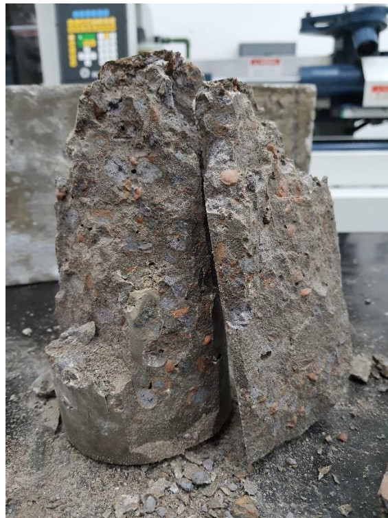
Figura 4.6 – Foto CP submetido ao ensaio de compressão TARG.
