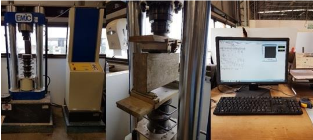
Figura 2.18 – Ensaio de tração na flexão. [32]
