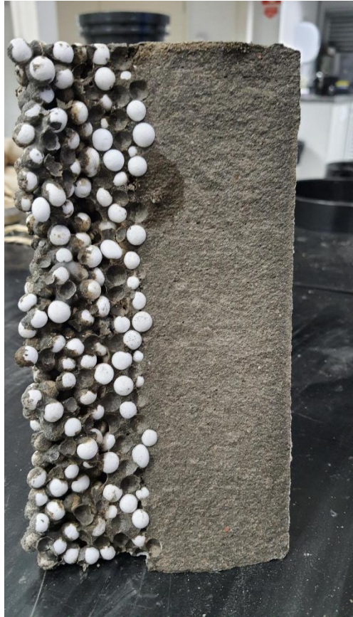
Figura 4.15 – Foto protótipo submetido ao ensaio de tração na flexão TEPS1.
