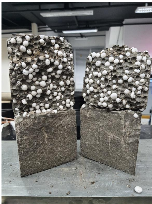
Figura 4.11 – Foto CP submetido ao ensaio de tração por compressão TEPS1.
