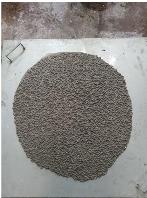
Figura 4.20 – Foto slump Flow TEPS3.
