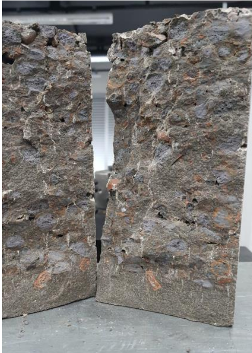
Figura 4.10 – Foto CP submetido ao ensaio de tração por compressão TARG.
