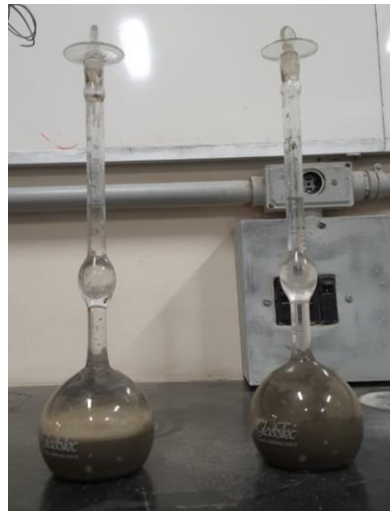
Figura 3.6 – Foto ensaio de massa específica, cimento.
