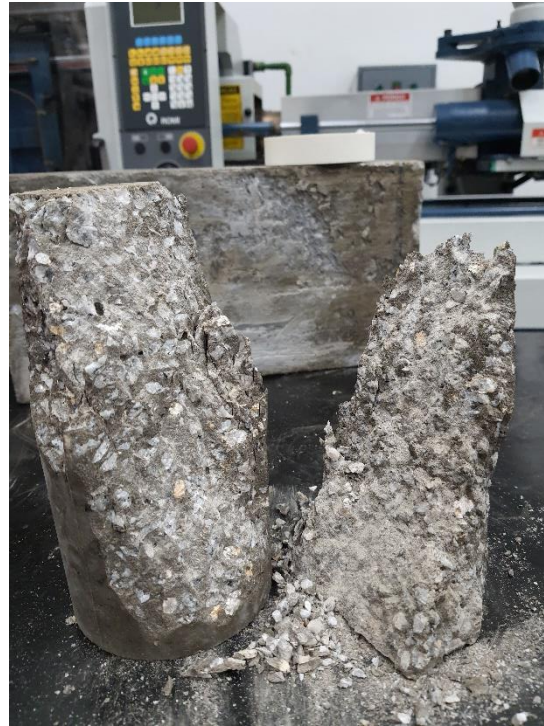
Figura 4.5 – Foto CP submetido ao ensaio de compressão TREF.
