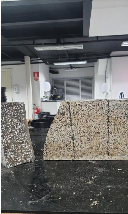
Figura 4.13 – Foto protótipo submetido ao ensaio de tração na flexão TREF.
