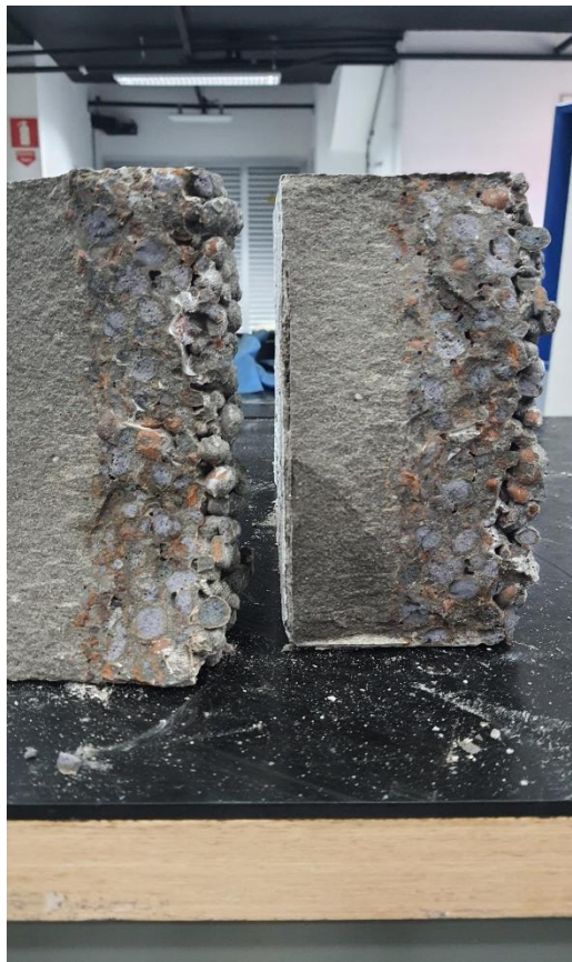
Figura 4.14 – Foto protótipo submetido ao ensaio de tração na flexão TARG.
