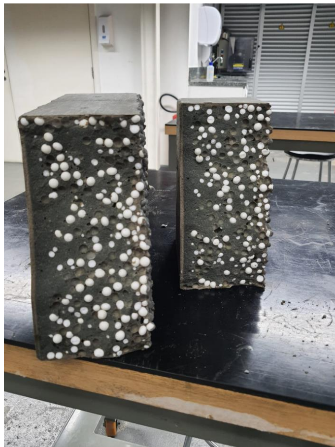
Figura 4.26 – Foto CP submetido ao ensaio de tração na flexão TEPS3.
