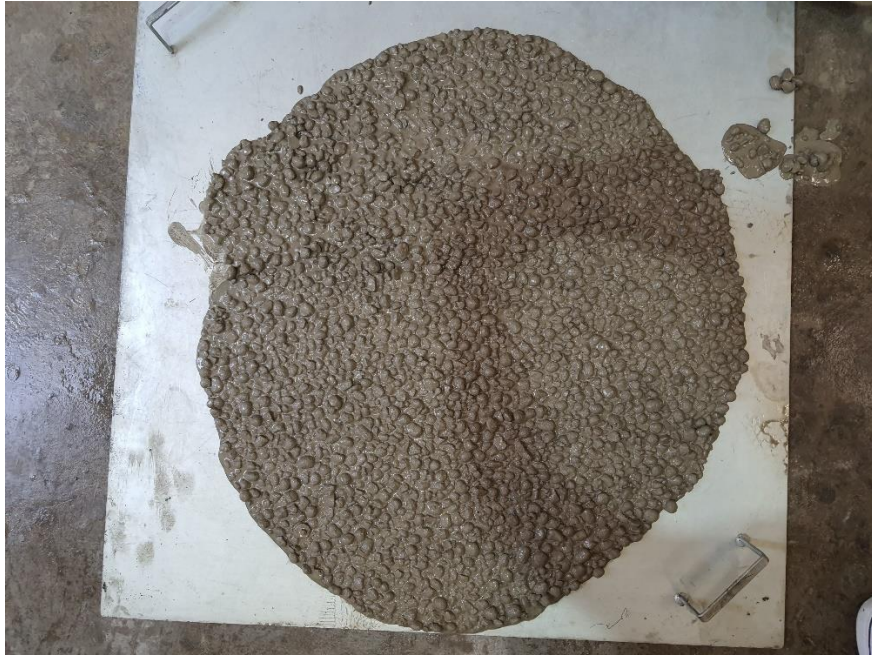
Figura 4.2 – Foto slump flow TARG.
