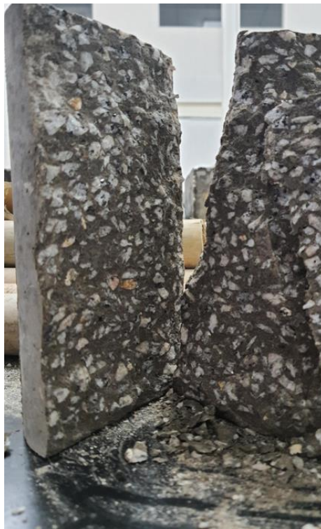
Figura 4.9 – Foto CP submetido ao ensaio de tração por compressão TREF.
