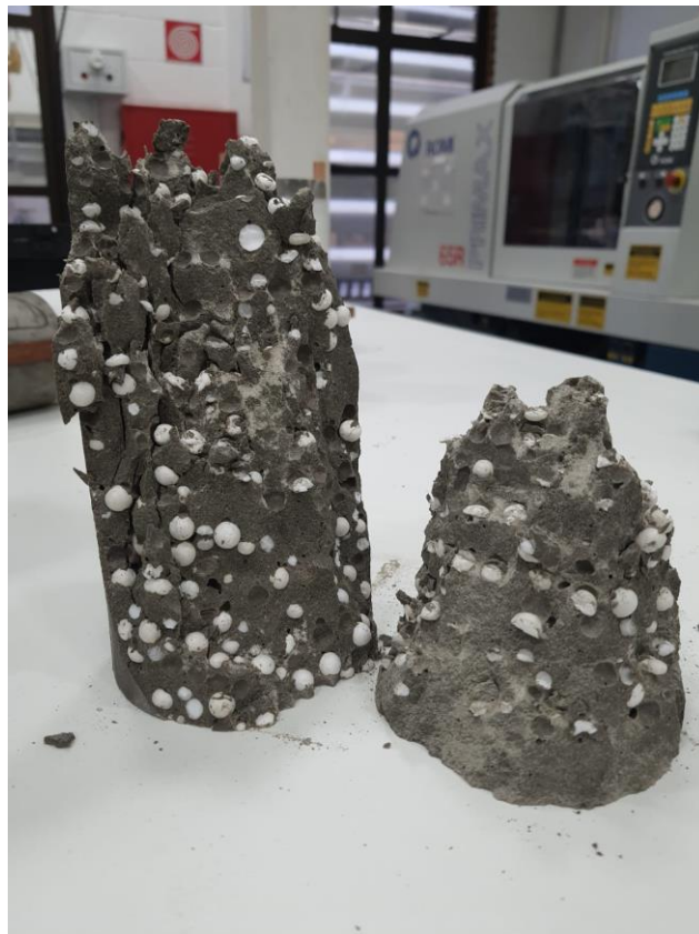
Figura 4.22 – Foto CP submetido ao ensaio de tração por compressão TEPS3.
