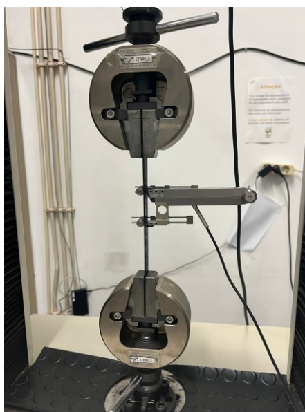
Figura 31 – Posicionamento do provete para o ensaio de tração
