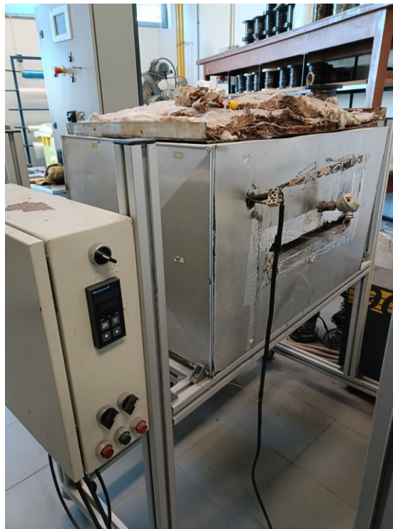
Figura 21 – Forno de pré-aquecimento
