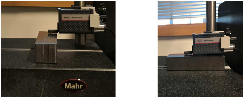
Figura 11 – Montagem utilizada para a medição da rugosidade. À esquerda, medição no sentido transversal, à direita, medição no sentido longitudinal.
