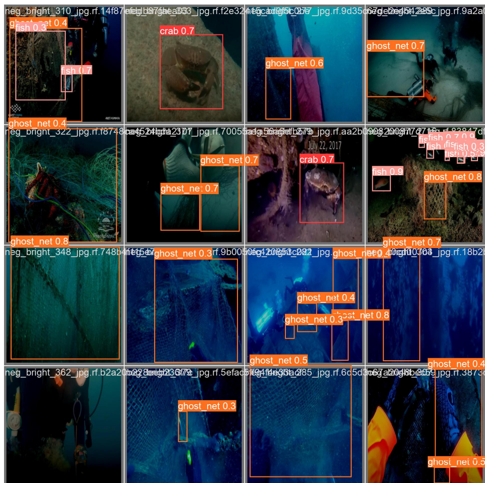
Figura 5.15: Inferência do YOLOv5 nano com um batch size de 128 no dataset de validação
