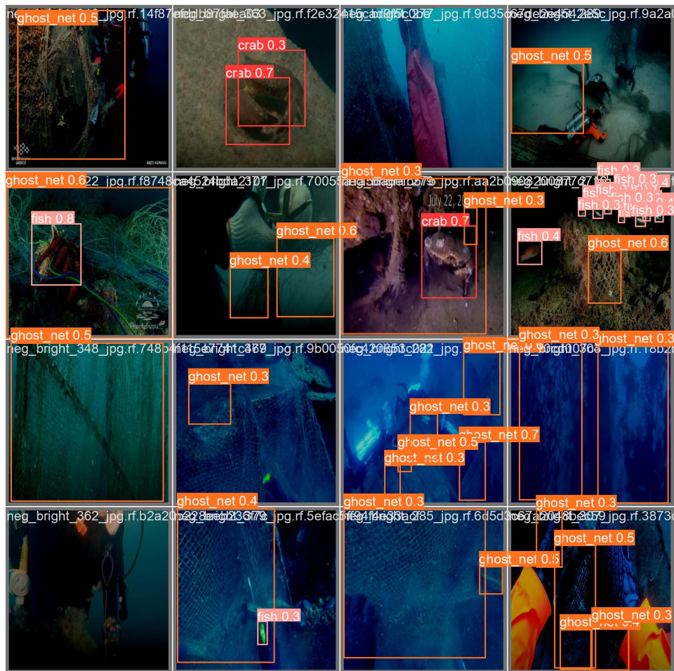
Figura 5.12: Inferência do YOLOv5 nano com um batch size de 32 no dataset de validação
