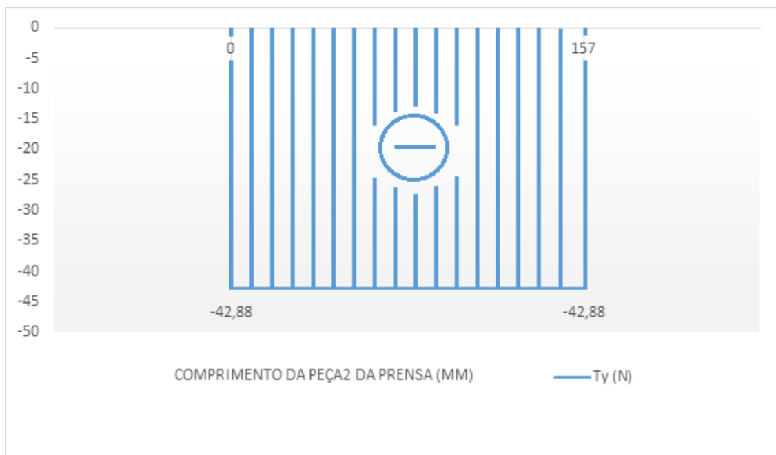
Figura 3-22- Diagrama do momento tórsor ao longo da peça2.
