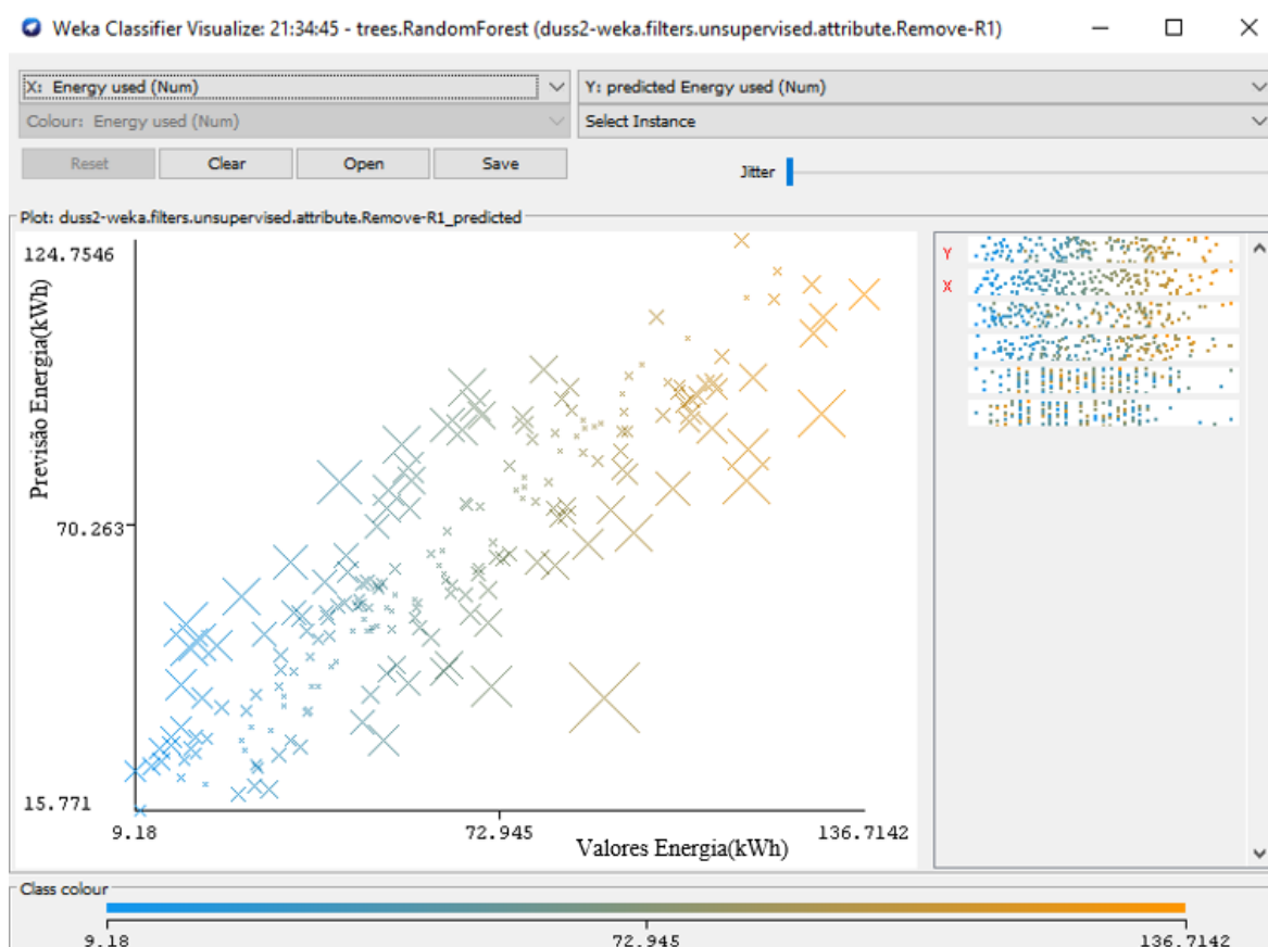
Figura 57- Comparação entre os valores reais e previsão obtidos com o modelo Floresta Aleatória
