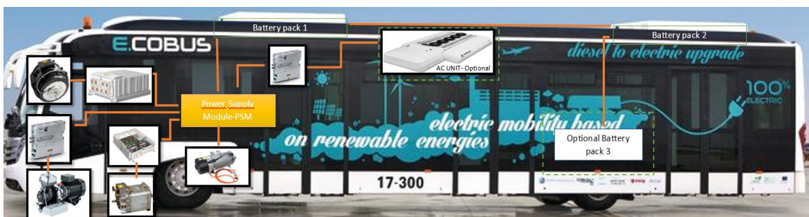
Figura 48- Diagrama representativo dos principais componentes (fonte: autoria própria)
