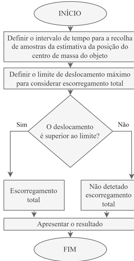
Figura 4.14: Fluxograma com a representação da abordagem utilizada para detetar escorregamento total.
