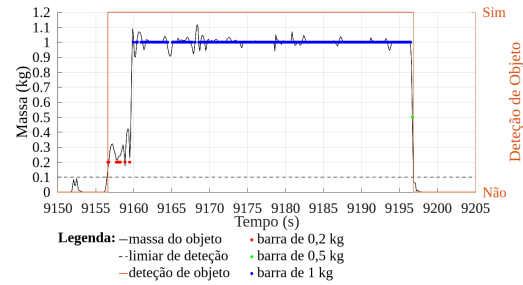
(f) Estimativa da massa ( \hat{m}_{obj} ), detecção e classificação do objeto durante a tarefa de manipulação n.º 4.
