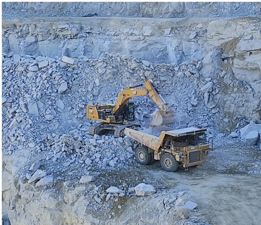
Figura 75 - Ciclo de carga e transporte em funcionamento
