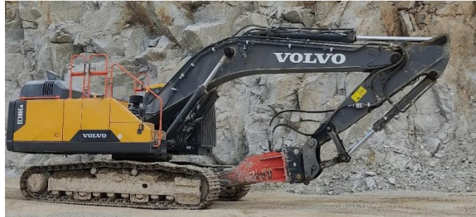
Figura 72 - Volvo 380 , acoplado de um martelo hidráulico
