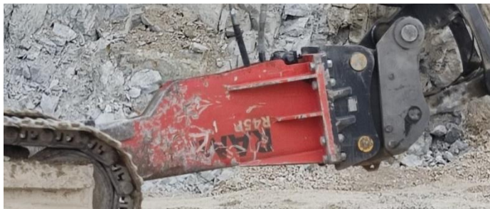
Figura 73 - Martelo hidráulico R45 instalado na Volvo 380
