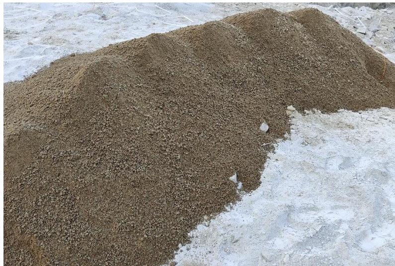
Figura 67 - Material utilizado para o tamponamento dos furos
