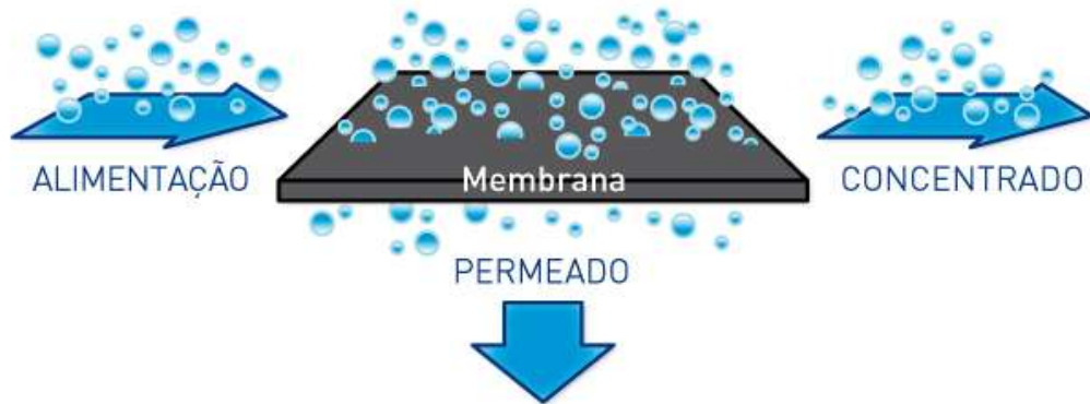
Figura 1.2 - Representação do processo de separação com membranas (Pentair 2018).
