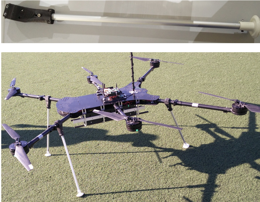
Figura 4.13: Versão melhorada do sistema de aterragem, com peças em nylon e amortecimento com mola, em cima, e demonstração das torções nos apoios, em baixo
