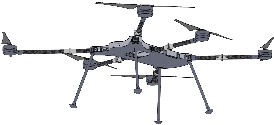
Figura 4.15: Apoios de aterragem finais.
