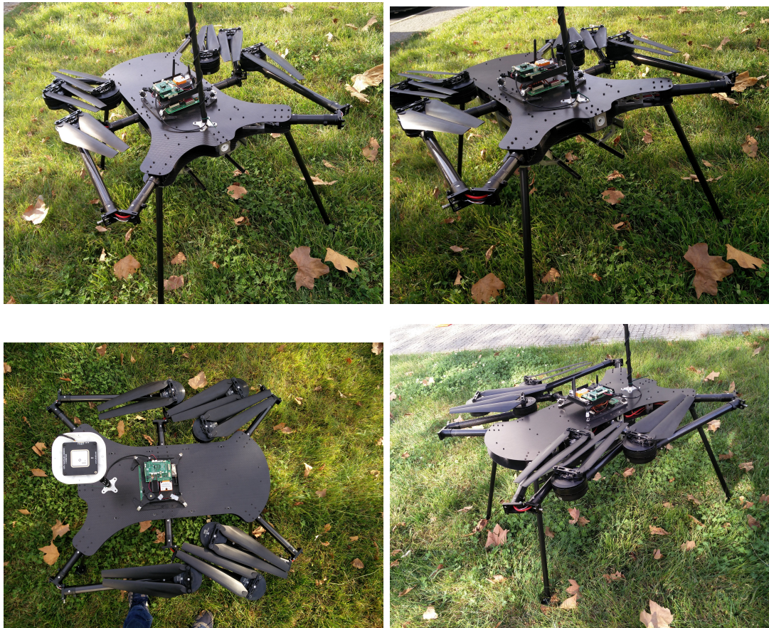
Figura 4.77: Fotografias reais do veículo com os braços fechados
