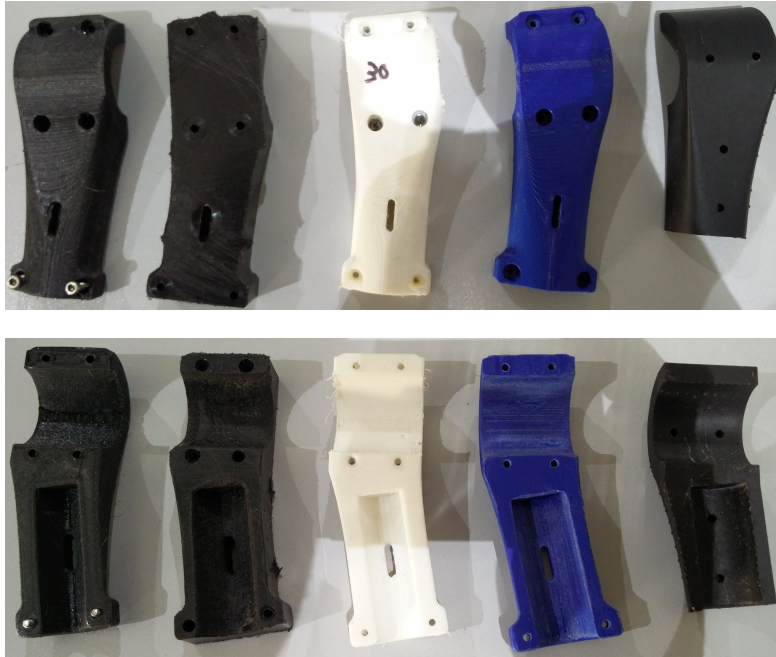
Figura 4.11: Peças de fixação em Nylon, PE-HD 500 (na CNC), TPU, ABS e Resina, da esquerda para a direita
