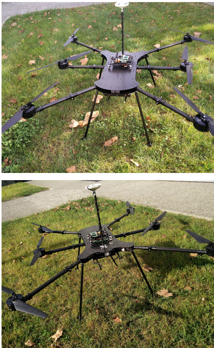
Figura 4.76: Fotografias reais do veículo com os braços abertos
