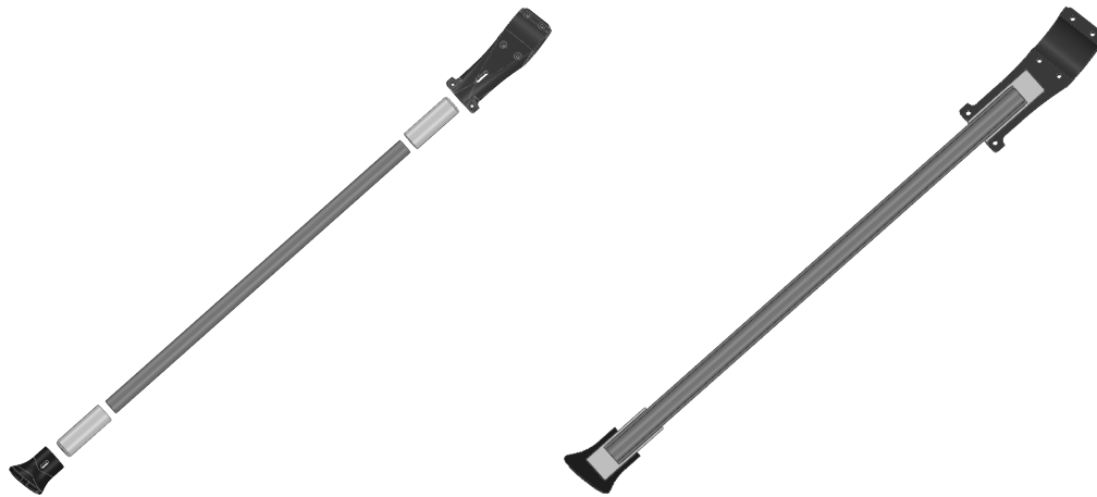
Figura 4.8: Primeira versão dos apoios de aterragem
