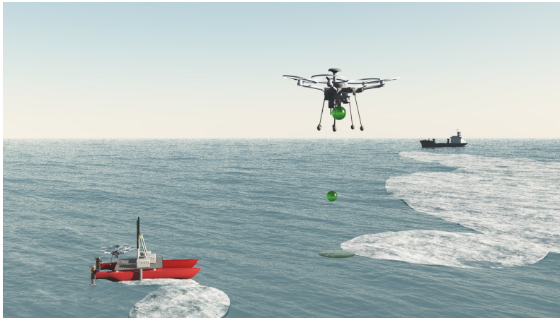
Figura 1.1: ROSM e SpilLess - coordenação multi-robô em operações de detecção e mitigação de derrames de petróleo
