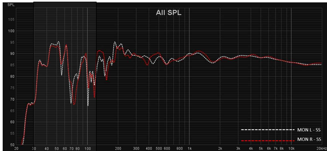
Figura 87 - Análise do impacto da atividade modal, na resposta em frequência dos altifalantes da sala, no Sweet Spot, para a sala “ESMAE – Estúdio B”
