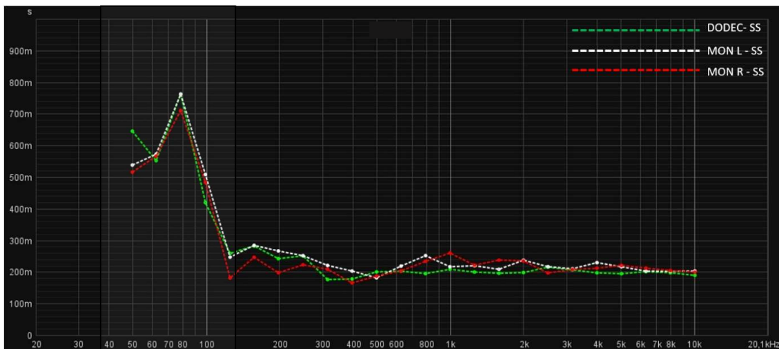
Figura 187 – Gráfico de T30 para o ponto SS e as fontes MON L, MON R, e DODEC, na sala “ESMAE – Régia A”
