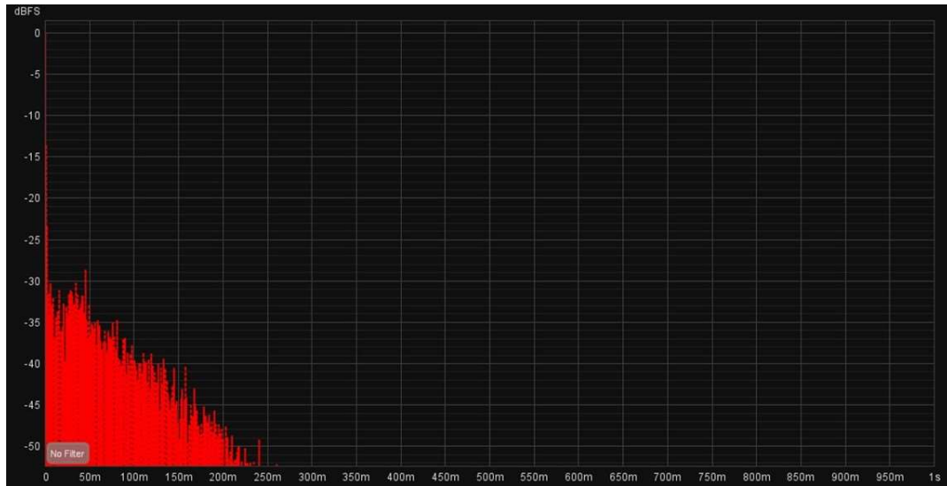
Figura 120 - Função de resposta ao impulso do par Fonte Sonora/Posição de Medição MON L – SS na sala “ESMAE – Laboratório de Música Eletrónica”
