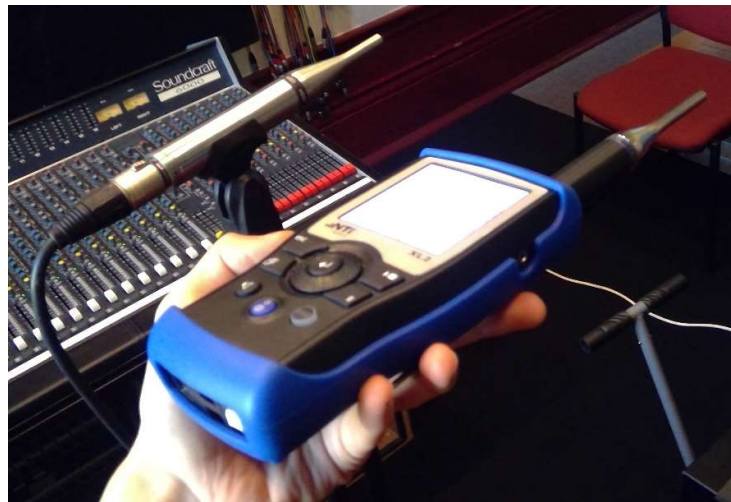
Figura 17 - Sonómetro NTI XL2 equipado com microfone calibrado (fotografia pelo autor)
