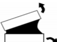
Figura 7 - Exemplo de esforços de clivagem [6]
