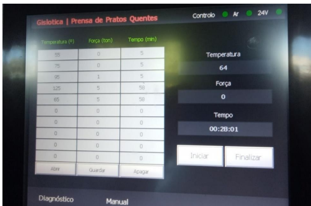
Figura 39 - Configuração da prensa de pratos quentes
