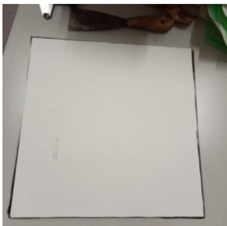
Figura 38 - Placa após compressão e empilhamento de 20 camadas
