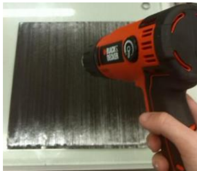
Figura 37 - Aquecimento das folhas carbono-epóxido
