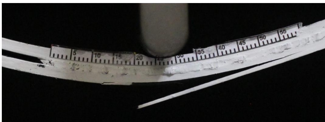
Figura 72 - Inexistência de propagação da fenda do provete ENF C0_1
