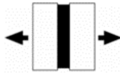
Figura 3 - Exemplo de esforços de tração [6]
