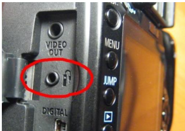
Figura 53 - Ligação do cabo Jack de 2,5 mm à entrada da ligação do comando
