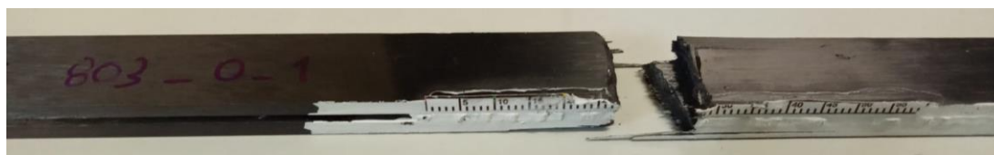
Figura 73 - Rotura total do provete ENF C0_1
