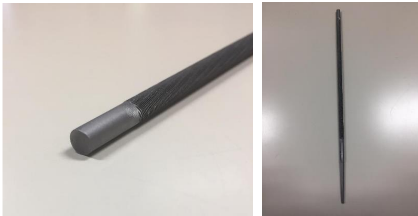
Figura 47 - Esboço da lima limpo
