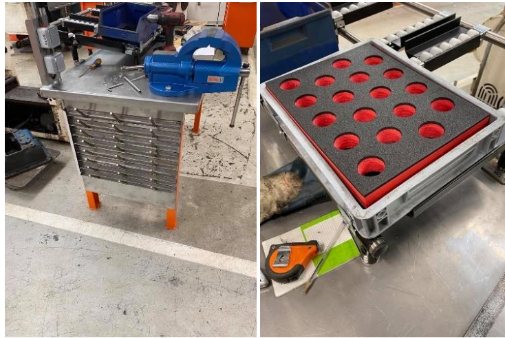
Figura 81 - Zona de alocação de réguas de retificação e boquilhas
