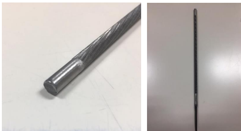
Figura 36 - Superfície do esboço de lima picado
