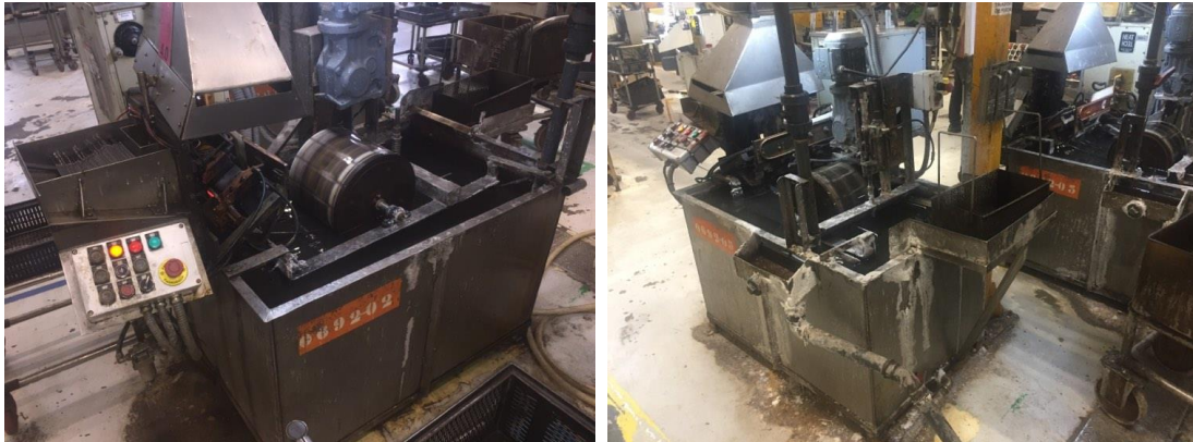
Figura 38 - Estação e equipamento da têmpera
