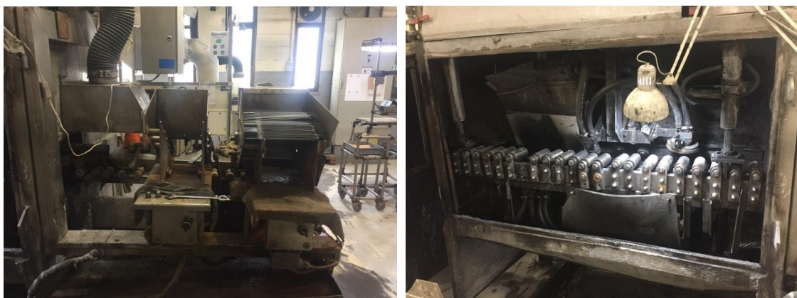
Figura 43 - Câmara/Tanque de decapagem
