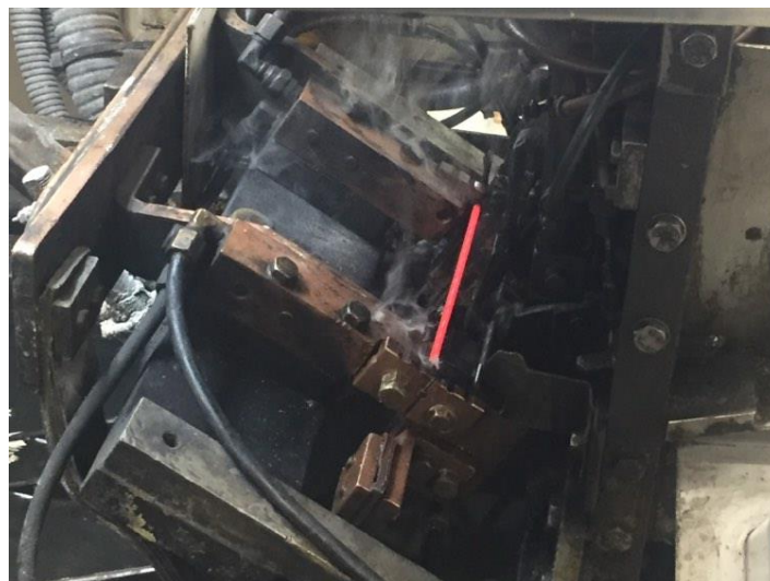
Figura 39 - Aquecimento do esboço da lima
