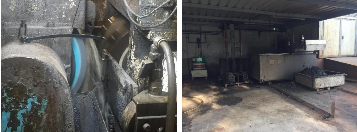
Figura 23 - Jato do fluido emulsão e estação de tratamento
