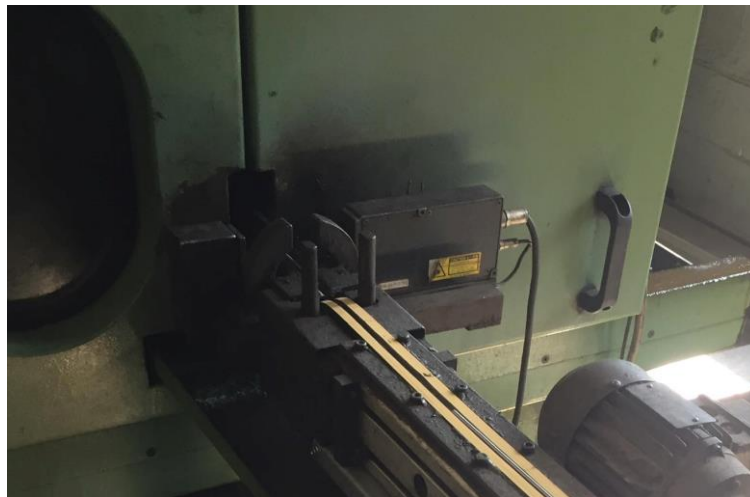
Figura 94 - Dispositivo Go/No Go automático da retificadora
