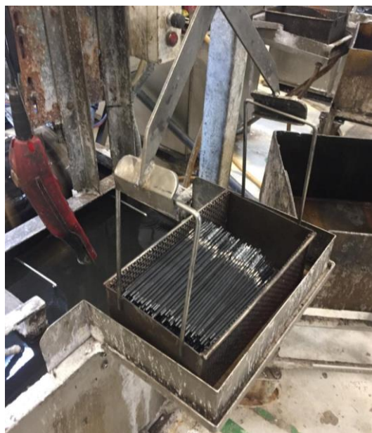
Figura 41 - Mecanismo de recolha dos esboços de lima temperados
