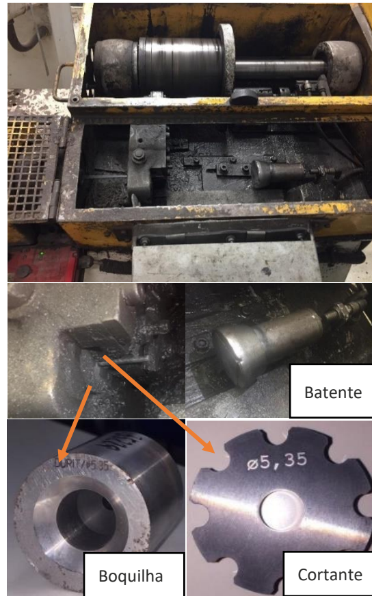
Figura 17 - Componentes do mecanismo corte
