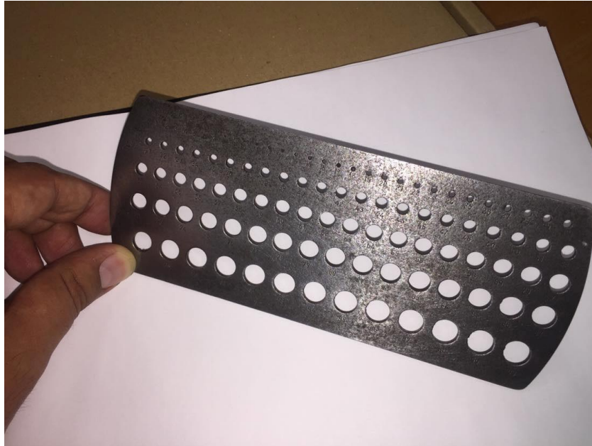
Figura 95 - Exemplo de instrumento Go/No Go manual para a retificação
