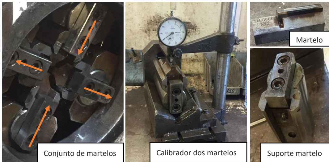
Figura 27 - Componentes do mecanismo de formação da espiga
