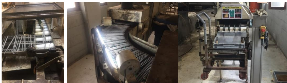
Figura 45 - Zona de secagem na máquina de limpeza
