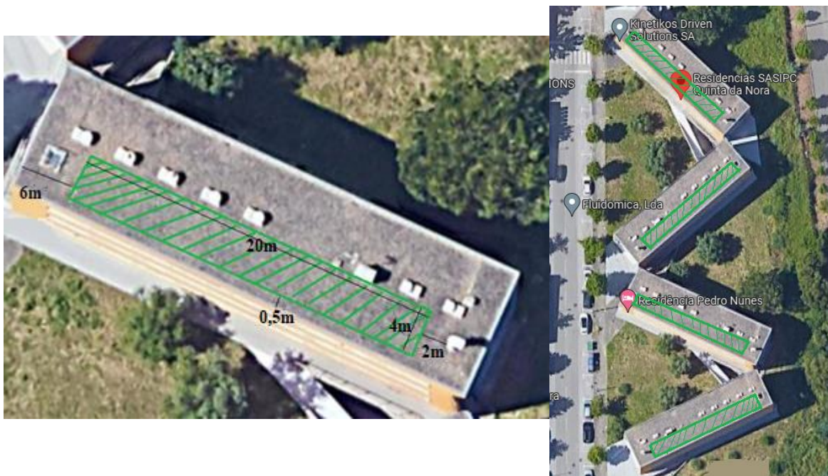
Figura 3-3: Área disponível para a instalação na residência Quinta da Nora
