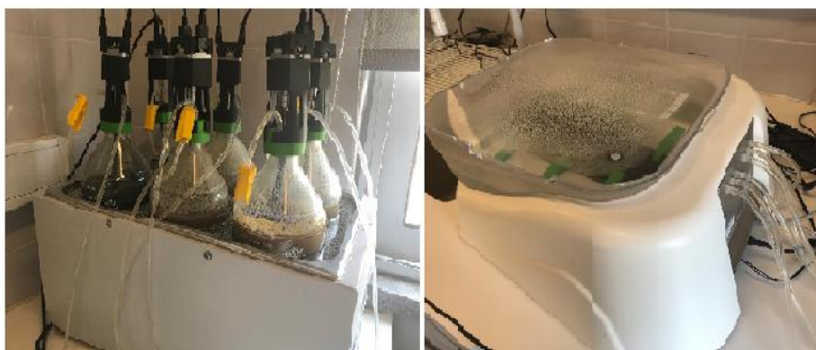
Figura 4.1 Montagem do sistema de produção de biogás em escala laboratorial (teste BMP)
